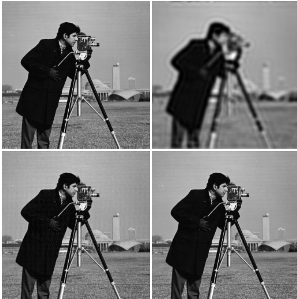
Abbildung 4.11: Zu sehen sind die Ergebnisbilder des Fourier-basierten quadratischen Variationsansatzes mit unterschiedlichen Werten für den Parameter \alpha . In diesem Fall wurde der Fourier-basierte quadratische Variationsansatz auf das Zylinder-gefaltete Bild angewendet. Oben links: Originalbild. Oben rechts: Fourier-basierter quadratischer Variationsansatz mit \alpha = 10^{-1} . Unten links: Fourier-basierter quadratischer Variationsansatz mit \alpha = 10^{-5} . Unten rechts: Fourier-basierter quadratischer Variationsansatz mit \alpha = 10^{-10} .
