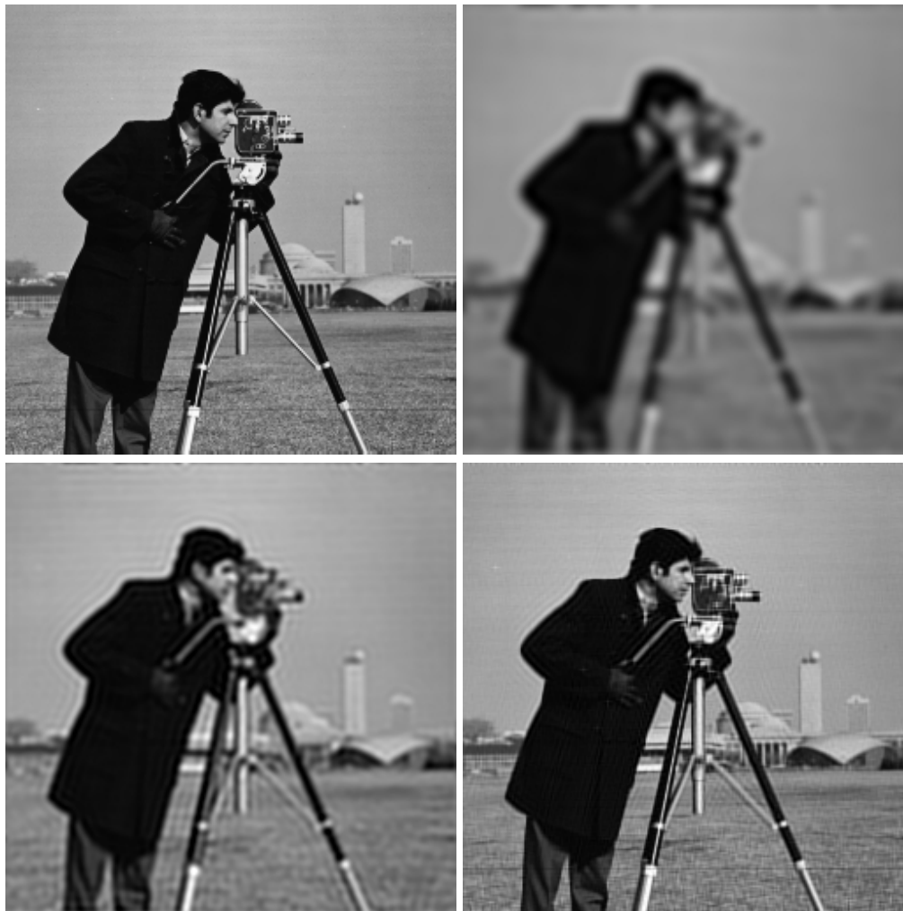
Abbildung 4.3: Zu sehen sind die Ergebnisbilder des Wiener Filters mit unterschiedlichen Werten für den Parameter K . In diesem Fall wurde der Wiener Filter auf das Gauß-gefaltete Bild angewendet. Oben links: Originalbild. Oben rechts: Wiener Filter mit K = 10^{-1} . Unten links: Wiener Filter mit K = 10^{-5} . Unten rechts: Wiener Filter mit K = 10^{-10} .
