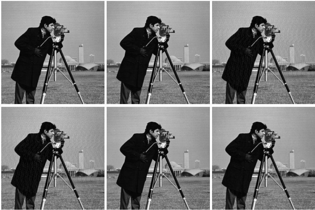
Abbildung 4.16: Zu sehen sind die Ergebnisbilder aller vorgestellten Verfahren. In diesem Fall wurden die Ansätze auf das Box-gefaltete Bild angewendet. Oben links: Originalbild. Oben mittig: Wiener Filter. Oben rechts: Quadratischer Variationsansatz (explizit). Unten links: Quadratischer Variationsansatz (stabilisiert). Unten mittig: Quadratischer Variationsansatz (Fourier). Unten rechts: Subquadratischer Variationsansatz (explizit).
