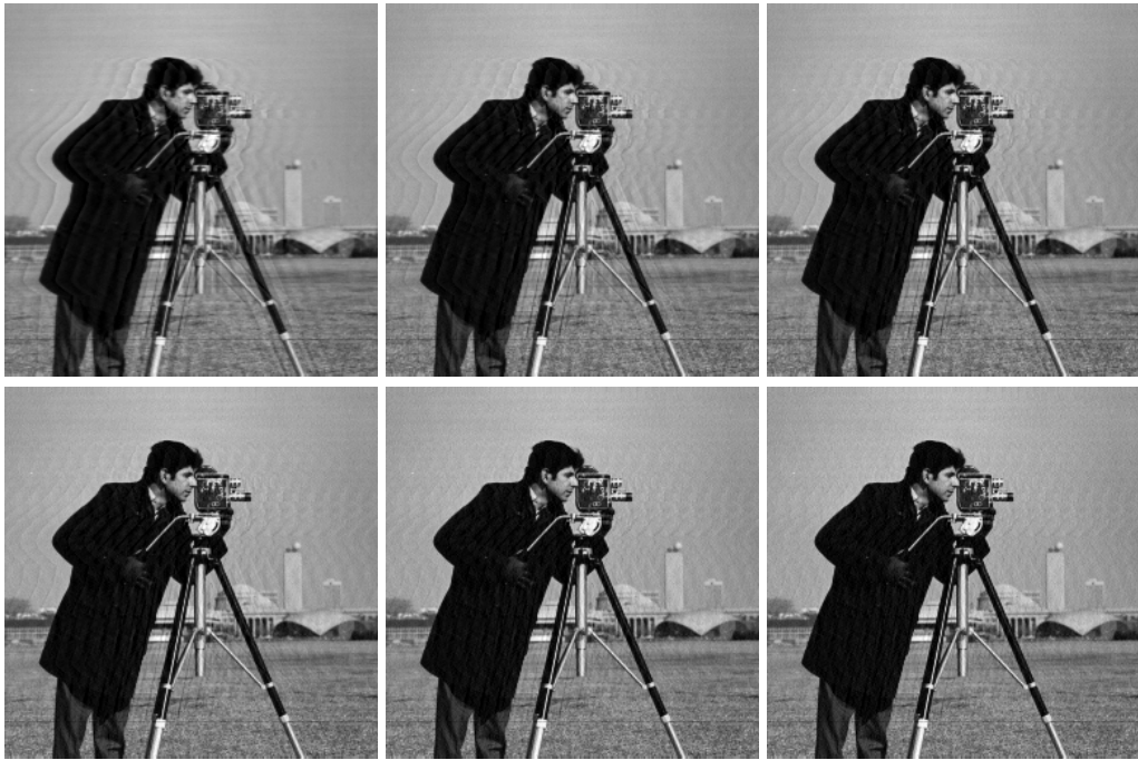
Abbildung 4.7: Zu sehen sind die Ergebnisbilder des expliziten quadratischen Variationsansatzes mit Gradientenabstieg mit unterschiedlichen Werten für den Parameter \alpha . In diesem Fall wurde der explizite quadratische Variationsansatz auf das Box-gefaltete Bild angewendet. Oben links: 100 Iterationen. Oben mittig: 300 Iterationen. Oben rechts: 500 Iterationen. Unten links: 1000 Iterationen. Unten mittig: 2000 Iterationen. Unten rechts: 3000 Iterationen.
