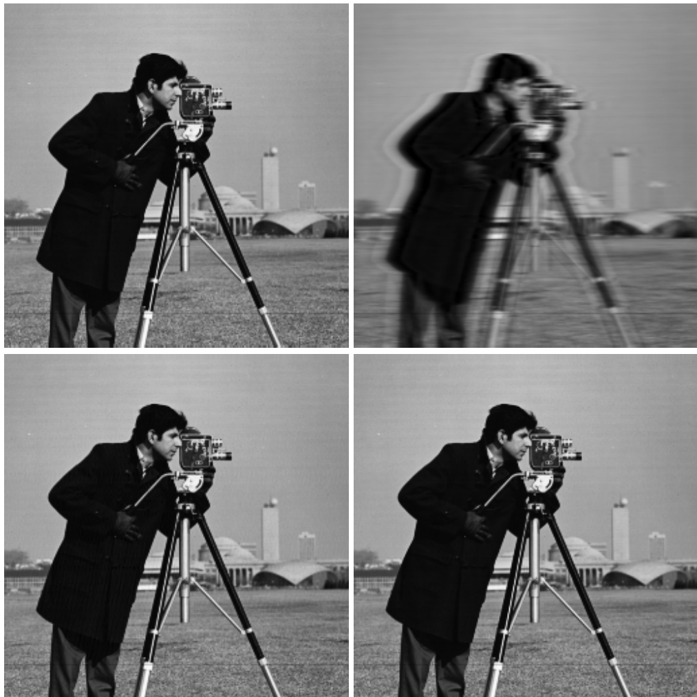
Abbildung 4.4: Zu sehen sind die Ergebnisbilder des Wiener Filters mit unterschiedlichen Werten für den Parameter K . In diesem Fall wurde der Wiener Filter auf das Box-gefaltete Bild angewendet. Oben links: Originalbild. Oben rechts: Wiener Filter mit K = 10^{-1} . Unten links: Wiener Filter mit K = 10^{-5} . Unten rechts: Wiener Filter mit K = 10^{-10} .
