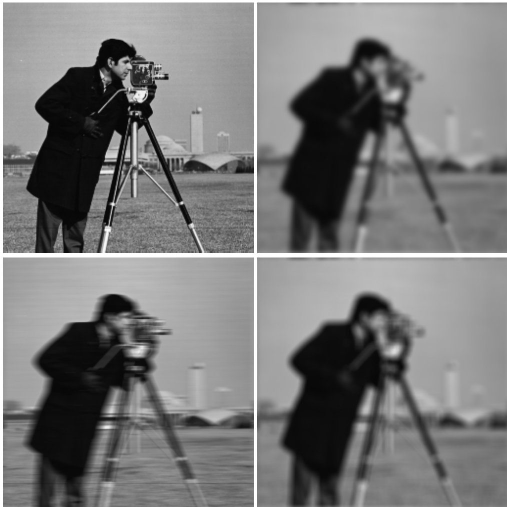
Abbildung 4.2: Hier werden das Originalbild und die gefalteten Bilder gezeigt. Die gefalteten Bilder werden den vorgestellten Verfahren unterzogen und die Resultate mit dem Originalbild verglichen. Oben links: Originalbild. Oben rechts: Gauß-gefaltetes Bild. Unten links: Box-gefaltetes Bild. Unten rechts: Zylindergefaltetes Bild.
