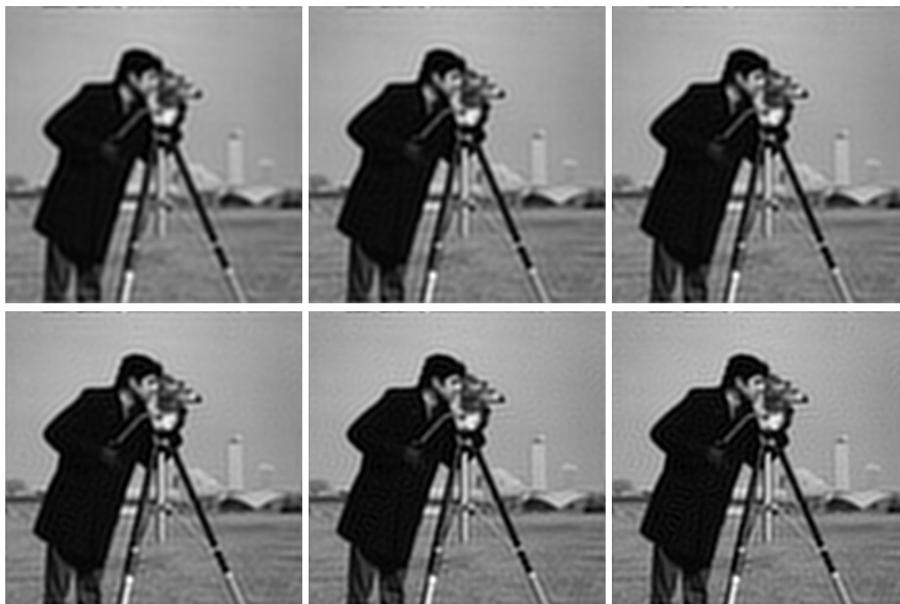
Abbildung 4.6: Zu sehen sind die Ergebnisbilder des expliziten quadratischen Variationsansatzes mit Gradientenabstieg nach unterschiedlich vielen Iterationen. In diesem Fall wurde der explizite quadratische Variationsansatz auf das Gauß-gefaltete Bild angewendet. Oben links: 100 Iterationen. Oben mittig: 300 Iterationen. Oben rechts: 500 Iterationen. Unten links: 1000 Iterationen. Unten mittig: 2000 Iterationen. Unten rechts: 3000 Iterationen.
