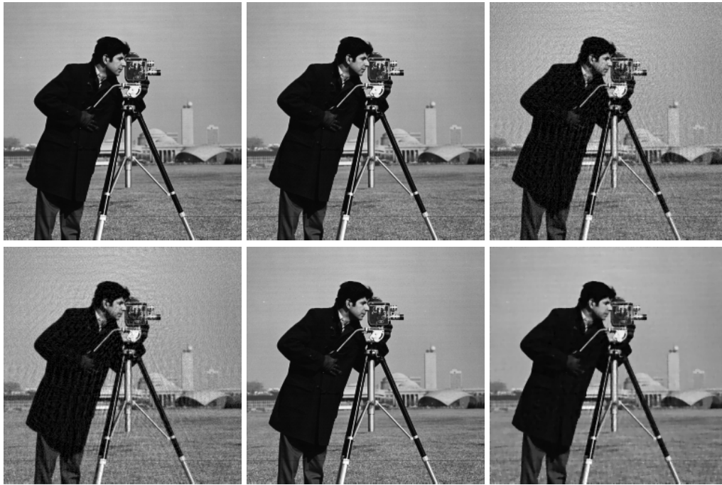
Abbildung 4.17: Zu sehen sind die Ergebnisbilder aller vorgestellten Verfahren. In diesem Fall wurden die Ansätze auf das Zylinder-gefaltete Bild angewendet. Oben links: Originalbild. Oben mittig: Wiener Filter. Oben rechts: Quadratischer Variationsansatz (explizit). Unten links: Quadratischer Variationsansatz (stabilisiert). Unten mittig: Quadratischer Variationsansatz (Fourier). Unten rechts: Subquadratischer Variationsansatz (explizit).
