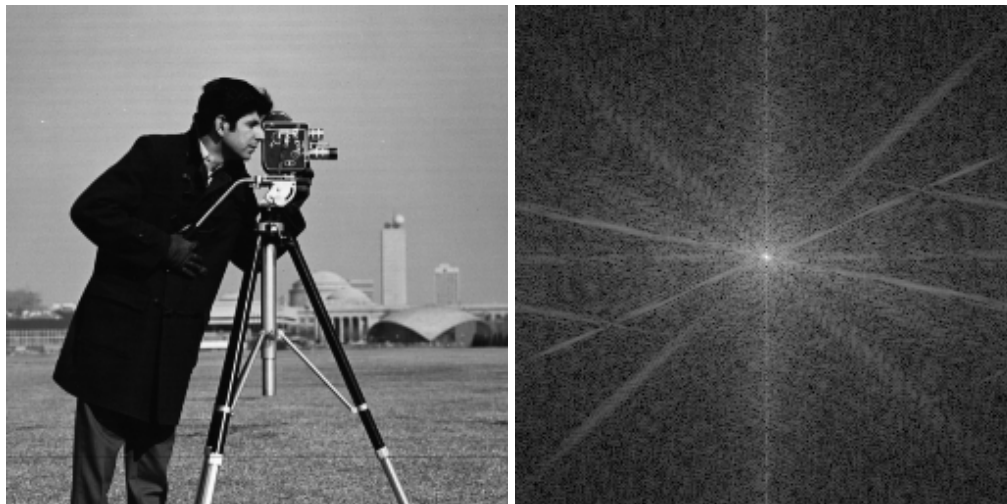
Abbildung 2.5: Es wird das Bild zusammen mit seinem zugehörigen Fourierspektrum gezeigt. Links: Originalbild. Rechts: Fourierspektrum des Originalbildes.
