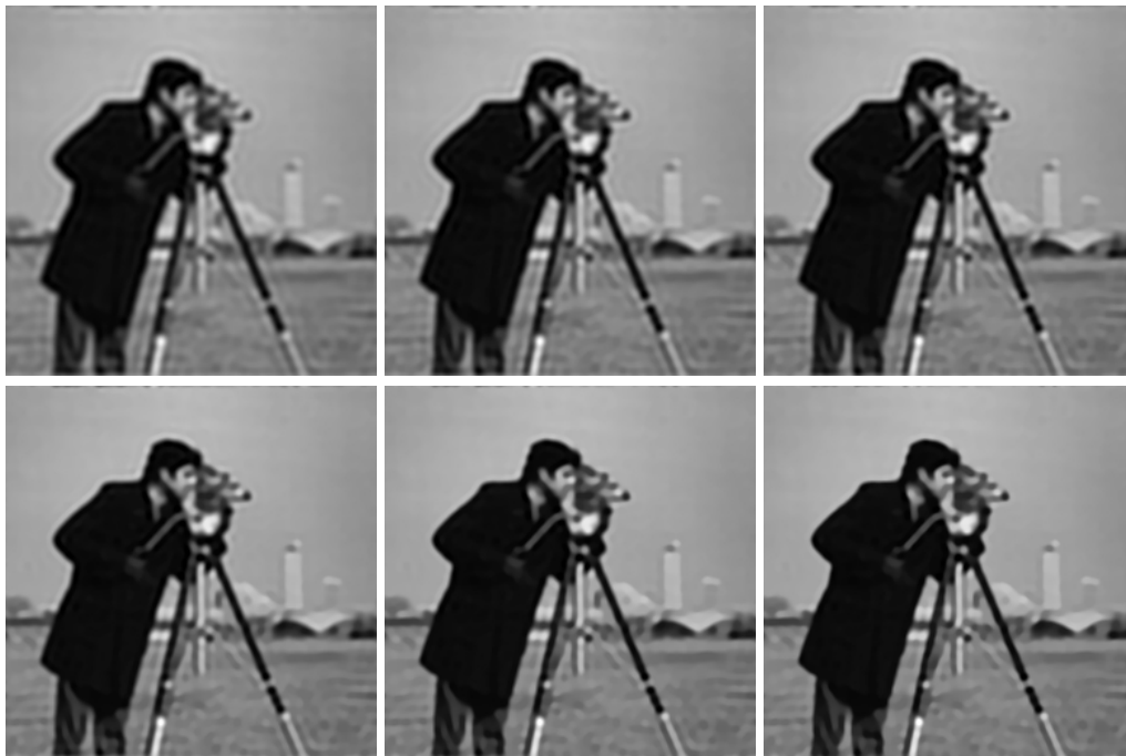
Abbildung 4.12: Zu sehen sind die Ergebnisbilder des expliziten subquadratischen Variationsansatzes nach unterschiedlich vielen Iterationen. In diesem Fall wurde der explizite subquadratische Variationsansatz auf das Gauß-gefaltete Bild angewendet. Oben links: 100 Iterationen. Oben mittig: 300 Iterationen. Oben rechts: 500 Iterationen. Unten links: 1000 Iterationen. Unten mittig: 2000 Iterationen. Unten rechts: 3000 Iterationen.
