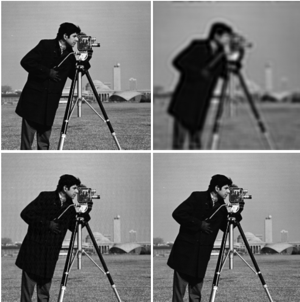
Abbildung 4.5: Zu sehen sind die Ergebnisbilder des Wiener Filters mit unterschiedlichen Werten für den Parameter K . In diesem Fall wurde der Wiener Filter auf das Zylinder-gefaltete Bild angewendet. Oben links: Originalbild. Oben rechts: Wiener Filter mit K = 10^{-1} . Unten links: Wiener Filter mit K = 10^{-5} . Unten rechts: Wiener Filter mit K = 10^{-10} .
