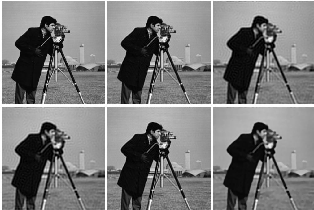
Abbildung 4.15: Zu sehen sind die Ergebnisbilder aller vorgestellten Verfahren. In diesem Fall wurden die Ansätze auf das Gauß-gefaltete Bild angewendet. Oben links: Originalbild. Oben mittig: Wiener Filter. Oben rechts: Quadratischer Variationsansatz (explizit). Unten links: Quadratischer Variationsansatz (stabilisiert). Unten mittig: Quadratischer Variationsansatz (Fourier). Unten rechts: Subquadratischer Variationsansatz (explizit).
