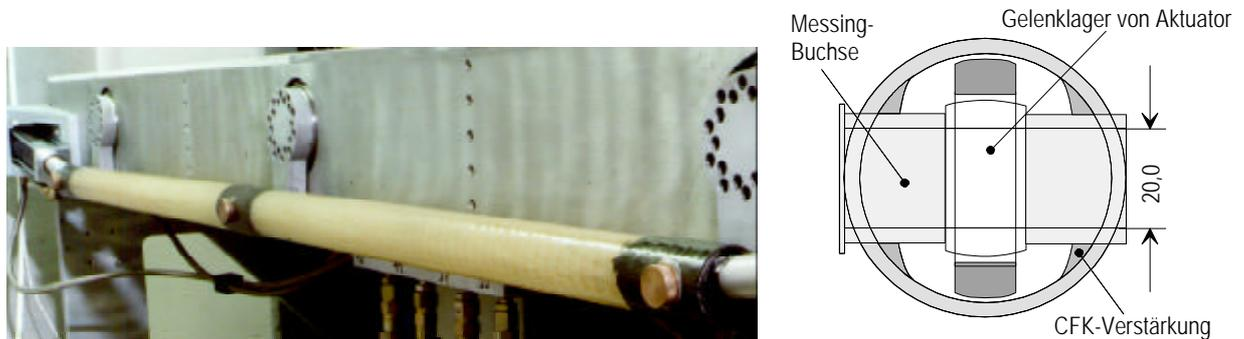
Bild 5.11: links: Zug/Druckstab mit drei CFK-verstärkten Kräfteinleitungsbereichen
