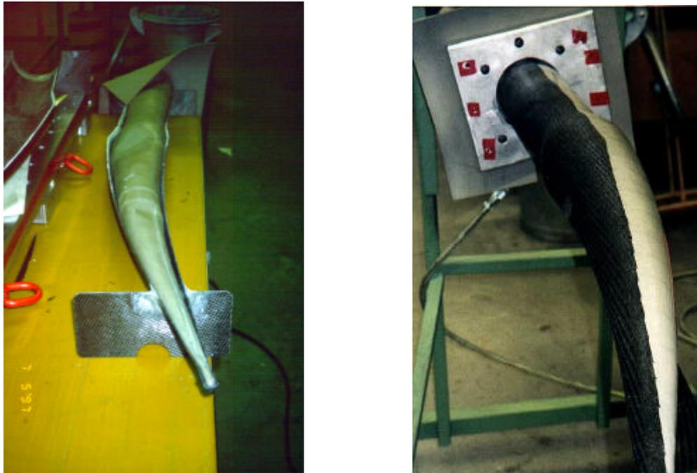
Bild 5.4: links: Dummyform mit eingelegtem Blasschlauch
