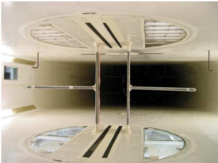
Abbildung 5.1 In-Flow-Array in der LWK-Messstrecke.
