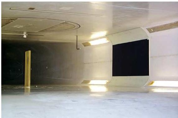
**Abbildung 3.41 Laminarwindkanal Stuttgart (LWK) mit WA und eingebautem Windkanalmodell.**
