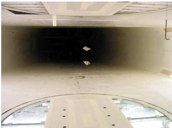
**Abbildung 4.20** Plastilin-Knoten, in der LWK-Messstrecke mit 0.1 mm-Stahldrähten fixiert. 2 Knoten in z-Richtung.
