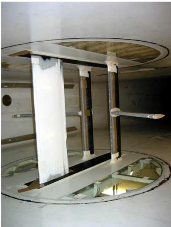
Abbildung 5.2 IFA mit eingebautem Windkanalmodell.
