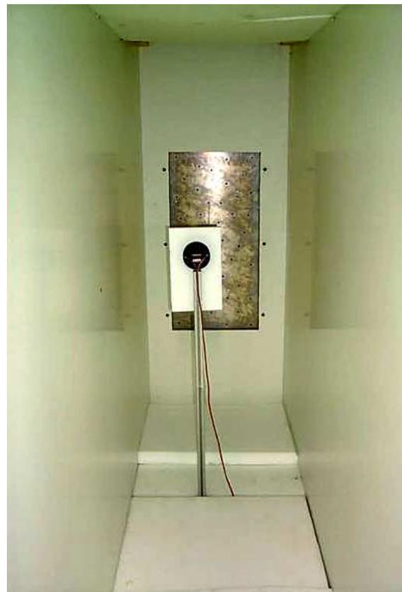
**Abbildung 4.13** Innenansicht des Messstreckenmodells mit einfacher Punktquelle
