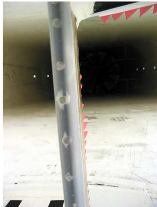
Abbildung 5.3 IFA, Mikrofon in der Profilnase, abgedeckt mit  $0.055 \text{ mm}$ -Gaze.
