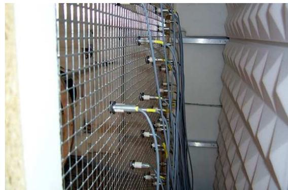
**Abbildung 3.38** Detailansicht des OFA. Mikrofonfixierung.
