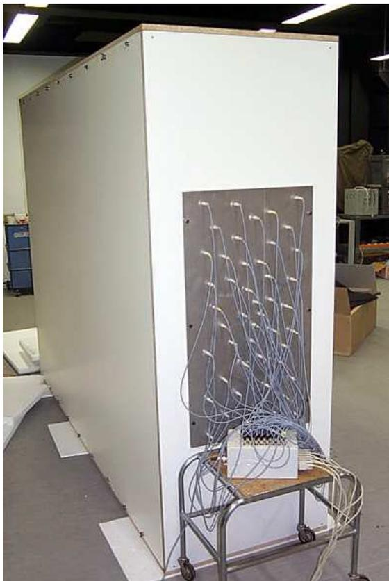
**Abbildung 4.12** Modell der LWK-Messstrecke mit 48 Kanal-Wall-Array
