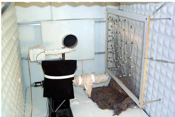
**Abbildung 3.37** Akustischer Windkanal Dresden (AWD) mit eingebautem OFA und der Elektro-Akustischen Punktquelle Modell 1 (EAP1).
