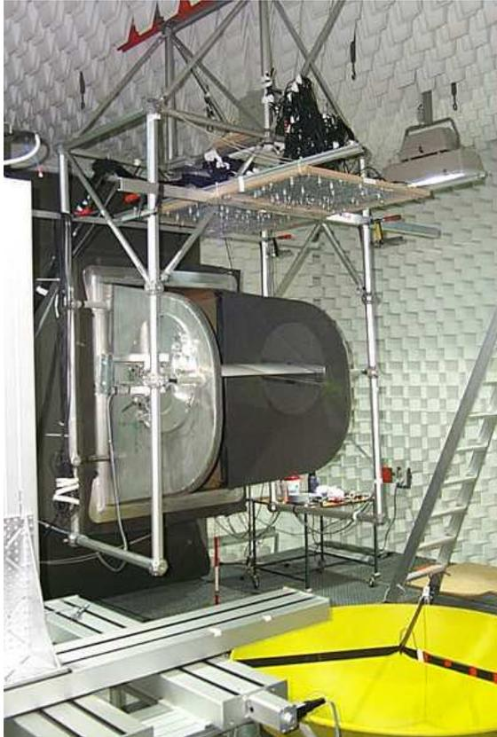
**Abbildung 3.39** Akustischer Windkanal Braunschweig (AWB) mit eingebautem OFA (oben) und Hohlspiegel (unten).
