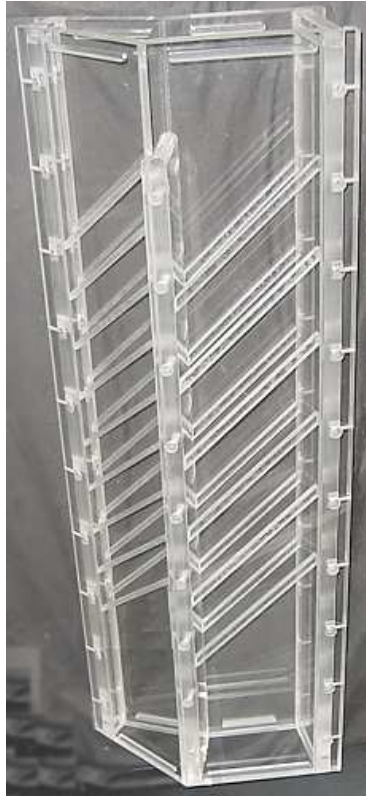
Abb. 3.5: Modellkanal aus Plexiglas, Skalierfaktor d=0,1\text{m} .
