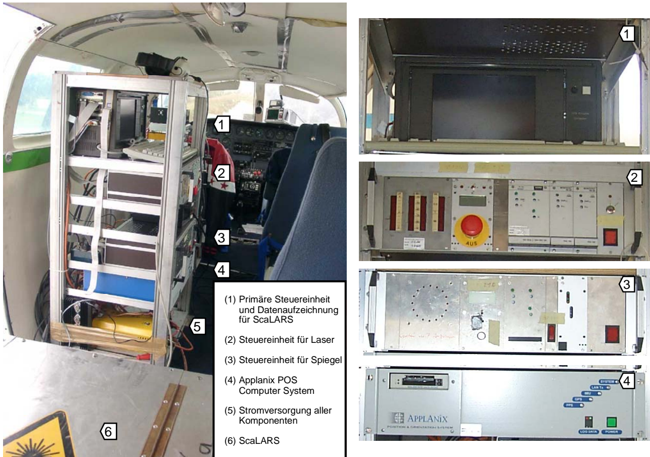
Abbildung 7.2: Aufbau des Messsystems mit Blickrichtung vom Heck zum Cockpit sowie in Frontansicht
