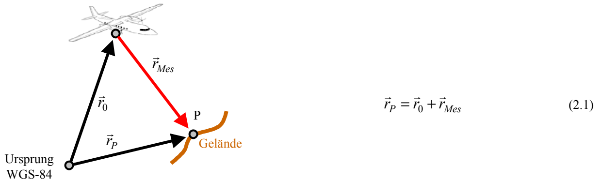
Abbildung 2.5: Vektorieller Ansatz zur Georeferenzierung
