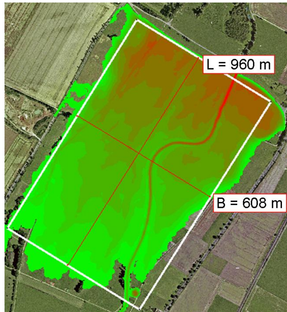
Abb. 7-10: Ermittlung des maximalen Längen- zu Breitenverhältnisses des Wasserkörpers in Trockenbecken.
