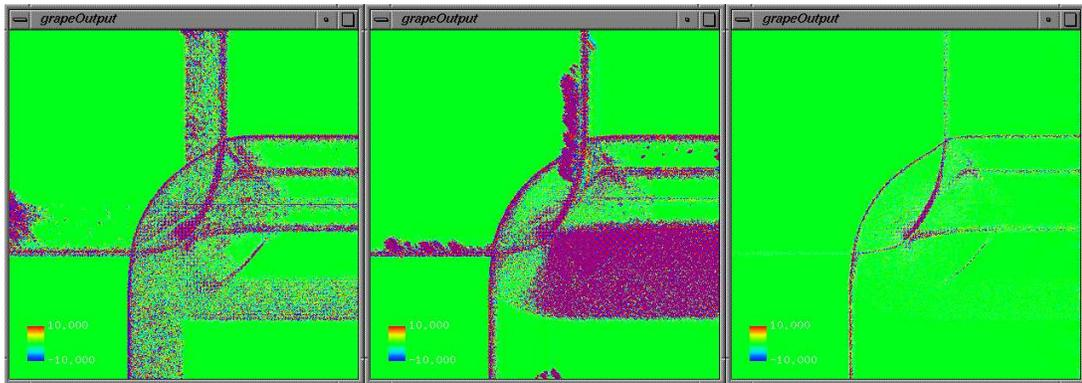
Abbildung 4.17: Divergenzverteilung beim 2-d Riemannproblem ohne Korrektur, mit Powellkorrektur bzw. mit gemischter GLM-Korrektur
