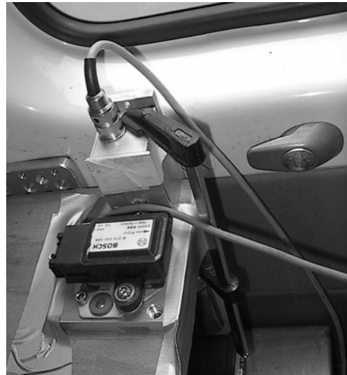
Abbildung 7-27: Montierter Beschleunigungsmesser mit Kreisel
