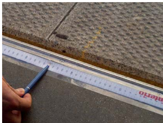
Abbildung 7-8: „Messaufbau“ zur Ermittlung der Haltegenauigkeit (perspektivisch)
