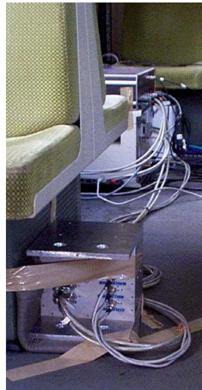
Abbildung 7-7: Messanordnung der INS-Plattform
