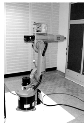
Abbildung 7-15: Kalibrierung der Kreisel mit Industrieroboter (WEBER 2002)
