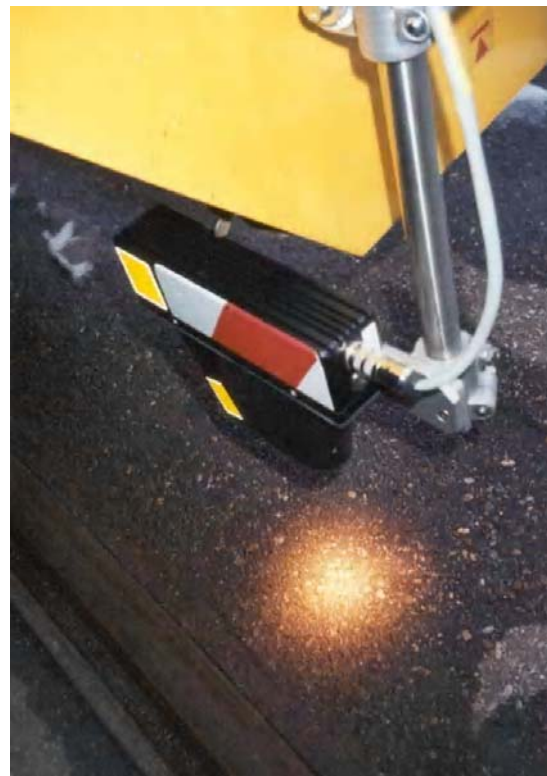
Abbildung 7-16: An der Stadtbahn montierter Korrelationsgeschwindigkeitsmesser (WEBER 2002)
