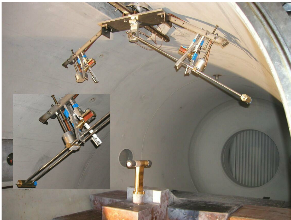
Abbildung 3.7: Pendelaufbau zur Diagnostik mit elektrostatischen Sonden. PLD2003
