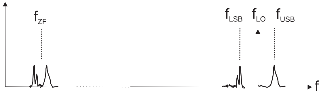
Abbildung 3.2: Frequenzumsetzung beim Heterodyn-Mischer. Zusammenhang zwischen Lokaloszillator-Frequenz f_{LO} , Signalfrequenzen f_{USB} (Oberes Seitenband) bzw. f_{LSB} (Unteres Seitenband) und Zwischenfrequenz f_{ZF} .
