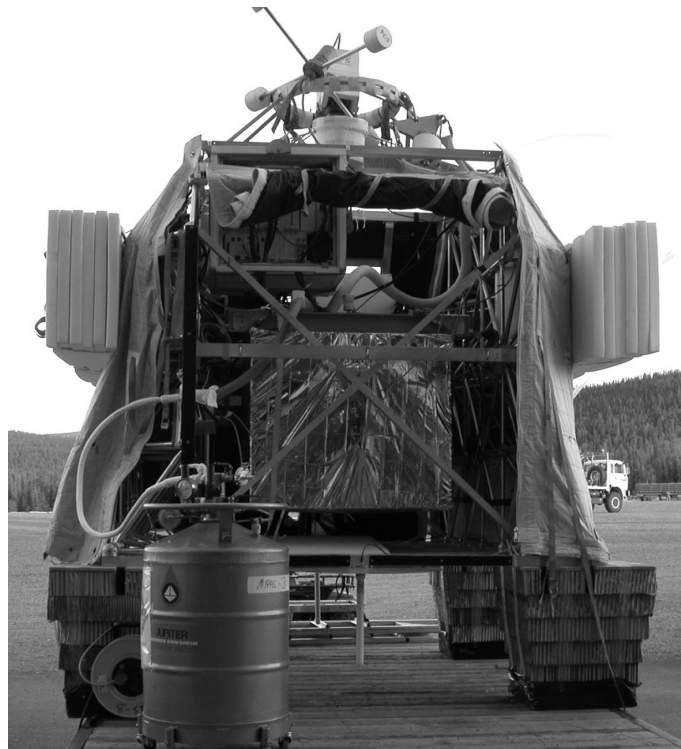
Abbildung 4.1: MIPAS-B2 Ballongondel. Seitlich und unterhalb der Gondel montierte Crashpads verringern die mechanische Belastung der Gondel bei der Landung und sollen so Beschädigungen am Instrument vermeiden. Die Gondel wird gegen die direkte Bestrahlung durch Sonnenlicht durch eine Schutzhülle abgeschirmt.
