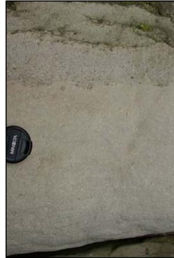
Abb. 5: Sandsteinbank innerhalb eines Sandstein-Schichtstapels in den Mittleren Deutenhausener Schichten. Innerhalb der Sandsteinbank weisen einzelne Einheiten unterschiedliche Korngrößen auf und stellen die Ablagerungen mehrerer Schüttungsereignisse dar. Wir interpretieren diese Gesteine als Ablagerungen sandiger Trümmerströme.
