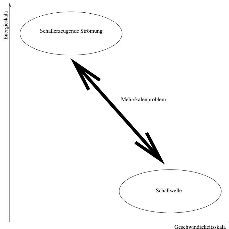
Abbildung 1.1: Mehrskaligkeit in der Aeroakustik
