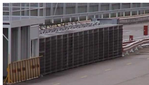
Abbildung 3.23: a) Vorbeifahrt an einer Seitenwindanlage b) Abbildung der Seitenwindanlage auf einem speziellen Testgelände
