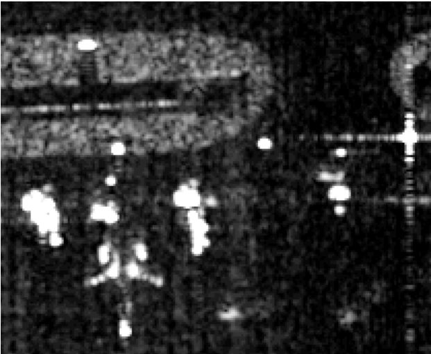
Abbildung 6-10: Flugzeuge im SAR-Bild setzen sich aus mehreren Reflexionszentren zusammen. Bild: DOSAR (EADS Deutschland)
