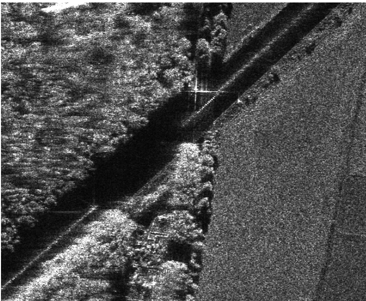
Abbildung 2-10: Verzerrung in Azimut durch Eigenbewegung der Bäume. Bild: DOSAR (EADS Deutschland)
