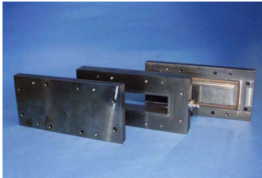
Abbildung 75: RTM-Werkzeug für die endkonturnahe Infiltration von Celanese-Druckproben
