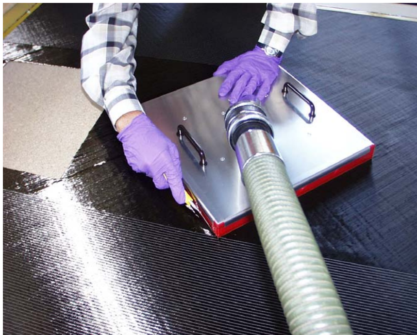
Abbildung 106: Saug-Hebehilfe für den Zuschnitt der unfixierten Faserlagen
