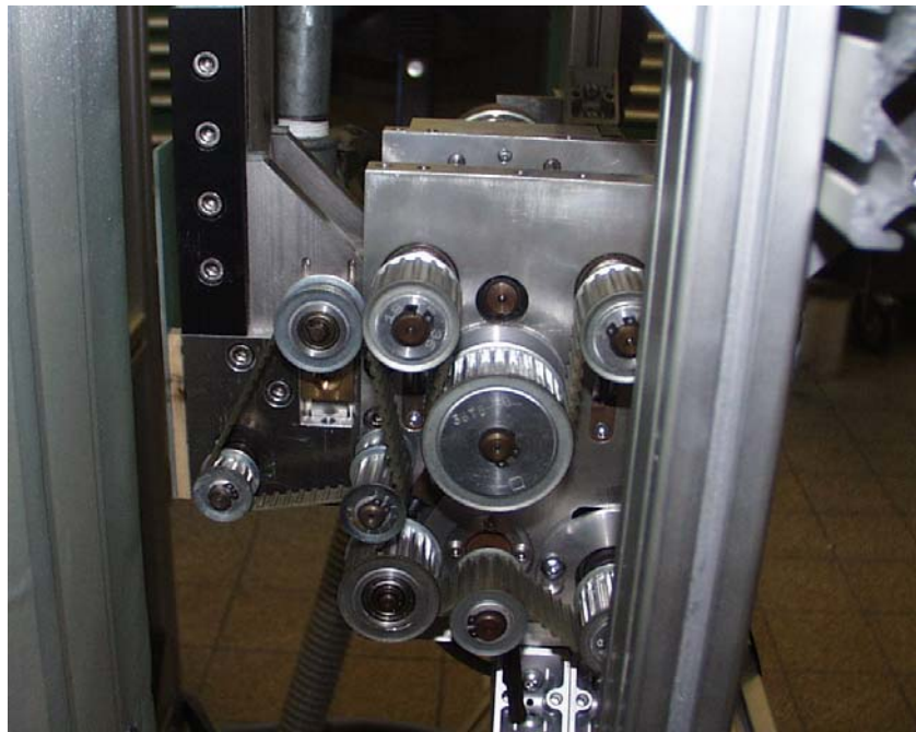
Abbildung 62: Kopplung zwischen Schneidwerk und Vakuumfließband
