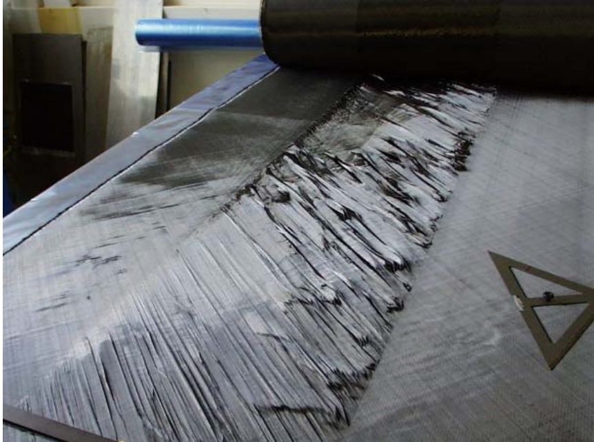
Abbildung 103: Durch Wickelvorgang und Transport beschädigtes Preformmaterial
