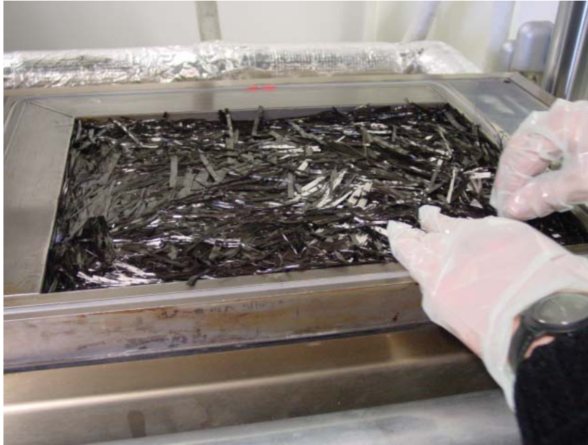
Abbildung 37: Füllen eines RTM-Formwerkzeugs mit kurzen Fasern
