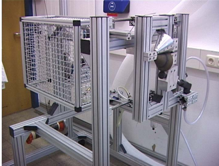
Abbildung 34: Erste Versuchsanlage mit Kegelschneidwerk
