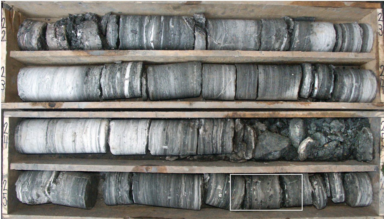
Abbildung 9.4: Bohrkerne aus den unausgelaugten Grundgipsschichten von Stuttgart-Bad Cannstatt. Das Sulfatgestein zeigt im markierten Bohrkernderschnitt örtlich geringe Spuren der Auslaugung.
