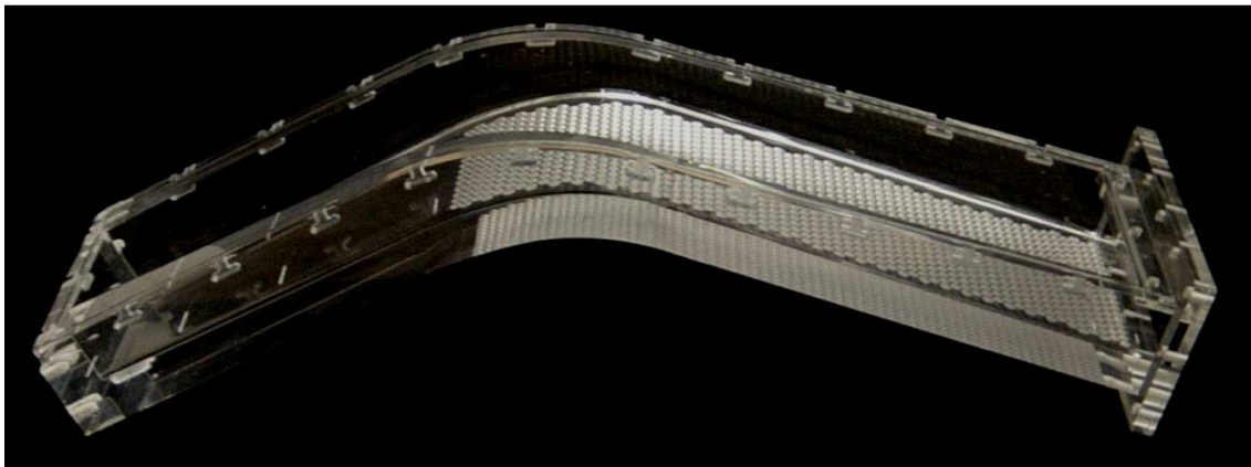
Abbildung 5.30.: Mit Dimples versehener Liner
