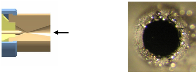
Abbildung 4.5: Photographie des divergenten Düsentails – Material WT20
