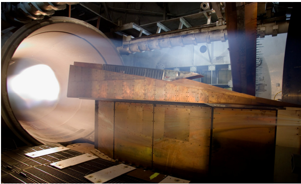
(a) Windkanaltest des PWR X1 Triebwerks
