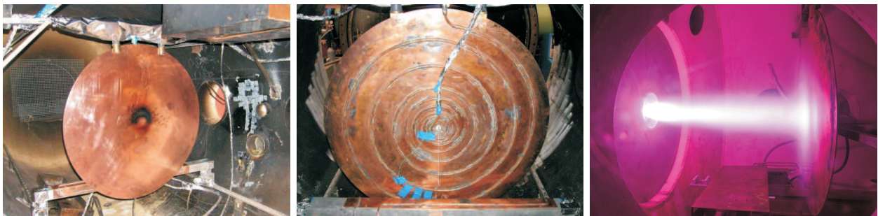
Bild 3.11: Vorder- und Rückseite der Prallplatte und während des Betriebs.
