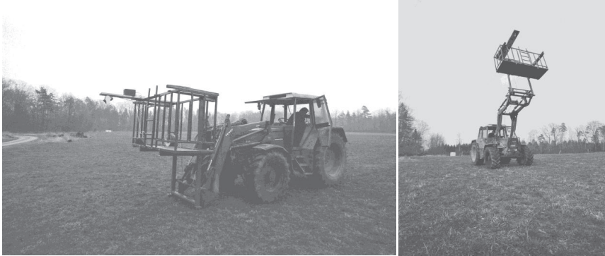
Abbildung 7-1: Fahrbare Versuchsplattform für die Sensorentwicklung.
