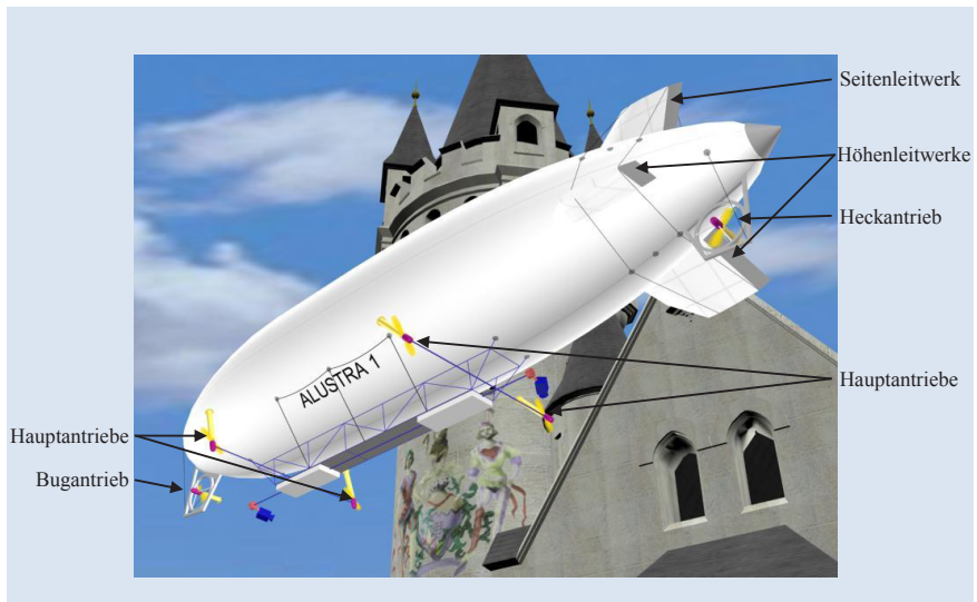
Abbildung 7-3: Anordnung der Aktuatoren am Versuchsträger ALUSTRA I
