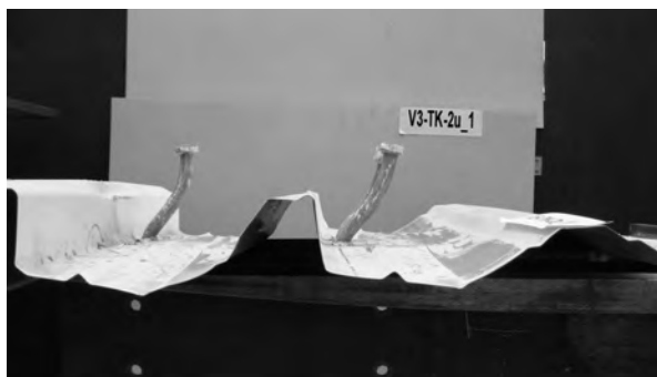
Kopfbolzenverformung am Versuchskörper V3-TK-2u Seite 1
