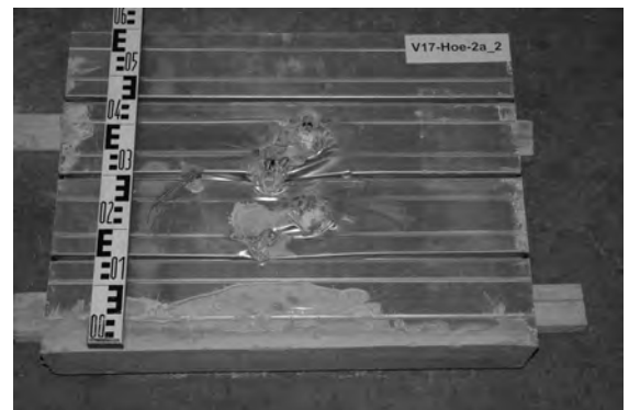
Bild 5.42: Ansicht Trapezblech V17-Hoe-2a nach Versuchsende
