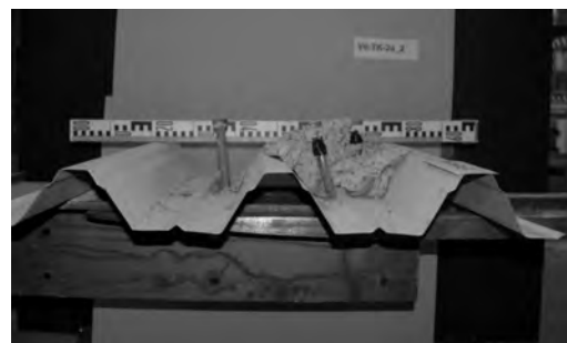
Kopfbolzenverformung bei V6-TK-2a Seite 2
