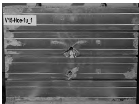
Innenansicht Trapezblech V15-Hoe-1u Seite 1
