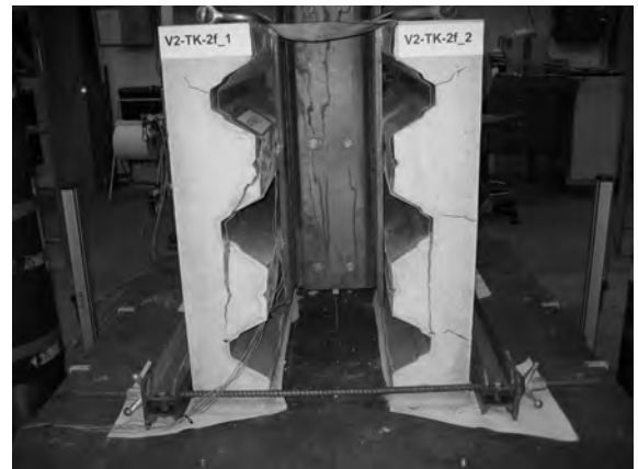
Abscheren weiterer Betonsicken bei V2-TK-2f
