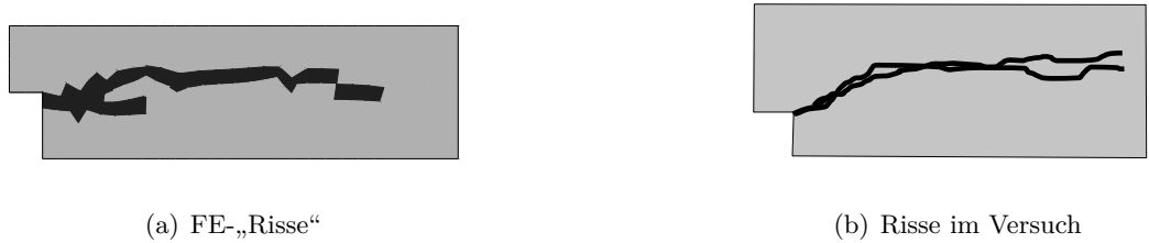
Bild 8.6: Gegenüberstellung der numerisch ermittelten plastischen Dehnungen („Risse“) und im Versuch beobachteten Risse (Skizze gefunden in Leukert [75])
