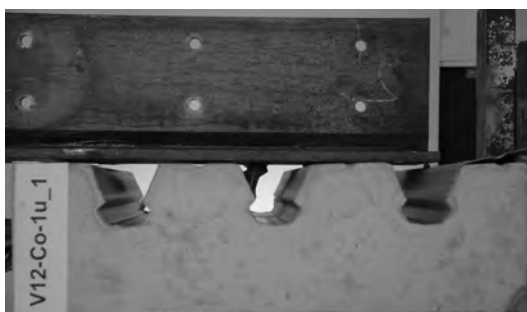
Betonausbruch V12-Co-1u Seite 1
