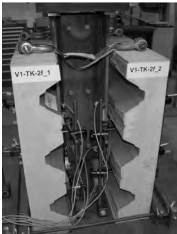
V1-TK-2f kurz nach Erreichen der max. Traglast
