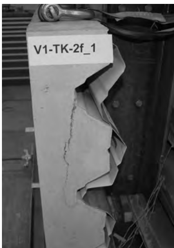
Abscheren der Sicke 1 bei V1-TK-2f
