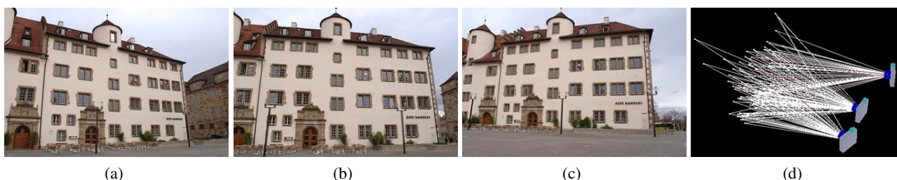
Abbildung 3.2: Fotoaufnahmen der Alten Kanzlei (a-c), Ergebnis der Bündelblockausgleichung (d).
