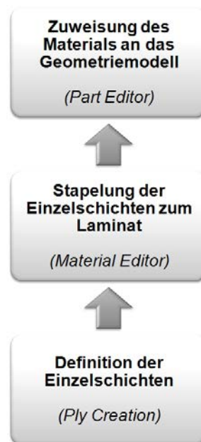
Abb. 4.19: Hierarchische Reihenfolge der Materialdefinition von der Einzelschicht über die Laminatorientierung zum Modell. [Sur10]
