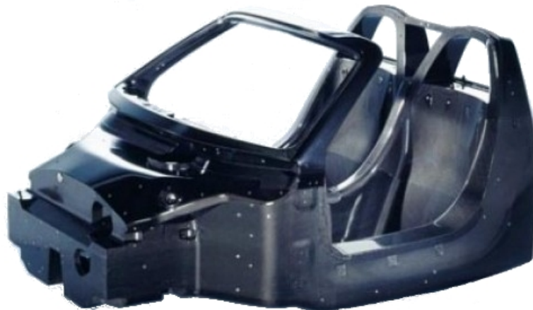
Abb. 6.1: CFK-Monocoque eines Porsche Carrera GT. Im Sportwagenbereich wird CFK bereits seit längerer Zeit für tragende Strukturen verwendet. [Quelle: Dr. Ing. h.c. F. Porsche AG]
