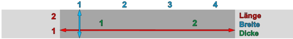
Abb. 4.4: Schematische Darstellung der Zugproben für die durchgeführten Kalibrierungsversuche mit eingezeichneten Messpunkten (hellgrau dargestellt sind die Aufleimer). [Sur10]
