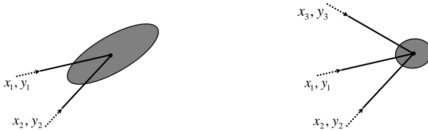
Abb. 5.16: Veränderung der Fehlerellipse durch zusätzliche Beobachtung von Pose P_3 ( P_1, P_2 \rightarrow P_1, P_2, P_3 )
