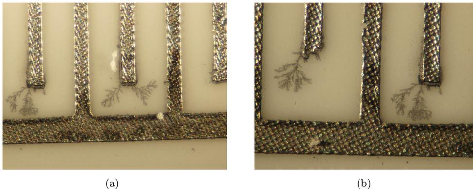
Abbildung 6.13.: Elektrochemische Migrationserscheinungen am coulometrischen Sensor
