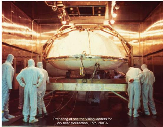
(a) Vorbereitungen eines Viking Landers zur Sterilisation mit trockener Hitze bei 111,7°C (Quelle: NASA)
