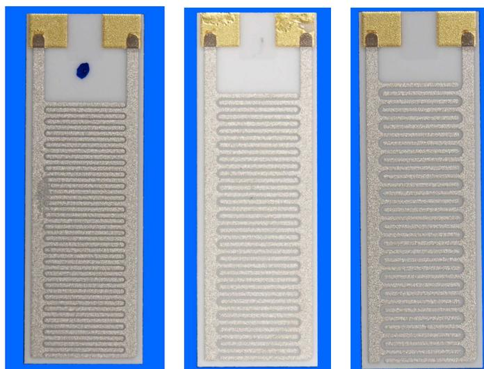
(a) SL4 II Elektrodenfläche  $153 \text{ mm}^2$ , Elektrodenlänge  $350 \text{ mm}$
