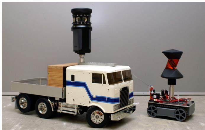
Abbildung 66: Fahrzeugmodelle im Baumaschinensimulator des IIGS
