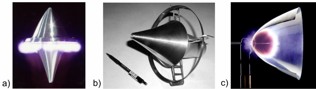
Abbildung 1.2: Demonstratormodelle für Laserantriebe: a) Lightcraft Technology Demonstrator, b) Aerospace Laser Propulsion Engine, c) Parabolisches Lightcraft (Bild: DLR). Nachdruck von Bild a) und b) mit freundlicher Genehmigung von L.N. Myrabo, bzw. Yu.A. Rezunkov.
