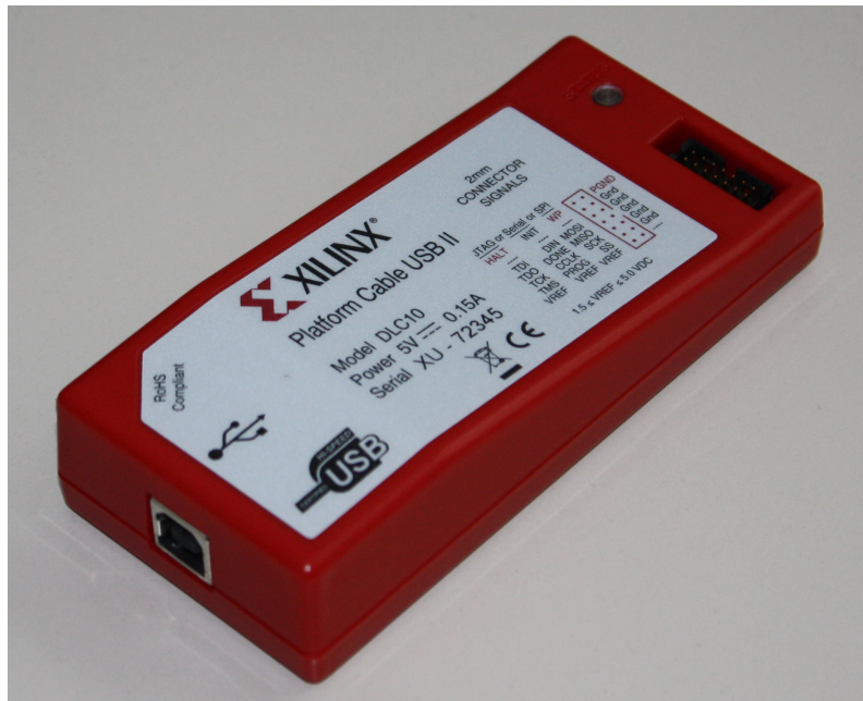
Abbildung 5.5: Xilinx Adapter zur Umsetzung von USB auf JTAG
