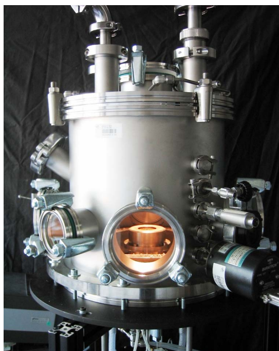
Abbildung 2.2: Niederdruckbrennkammer mit eingebautem Brenner.
