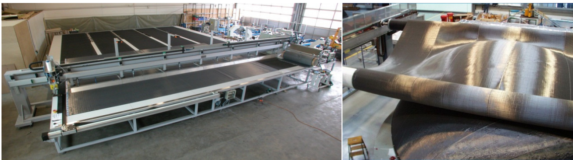
Abbildung 21: Portalanlage der Fa. Saertex zur Vernähung der Druckkalotte des A380 (rechts) und automatisiertes Drapieren der vernähten Preform auf dem Werkzeug (rechts) (nach Vortrag „Research project: Automated preform manufacturing in the process chain“ von Manuel Herkt, 4th EADS Advanced Technology Workshop 2005)
