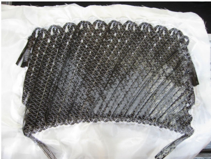
Abbildung 74: Detaildarstellung eines Probensegments für die Ermittlung der Nähparameter
