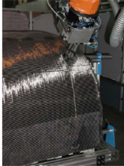
Abbildung 20: Blindstichnaht an der Rumpfsseitenschale des Eurofighter-2000 [Geßler et al. 2002]
