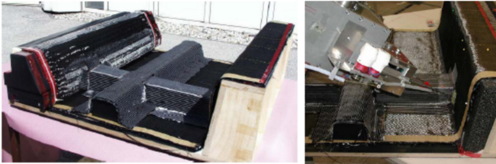
Abbildung 17: Bodengruppenpreform vor dem Vernähen (links) und Tuften des Sitzträgeranschlusses an den Tunnel (rechts) [Geßler et al. 2002]
