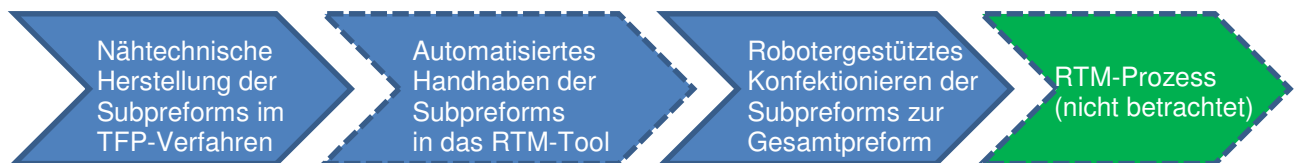
Abbildung 65: Die entwickelte Prozesskette zur Herstellung von Carbonpreforms und deren automatisiertes Fügen im RTM-Tool
