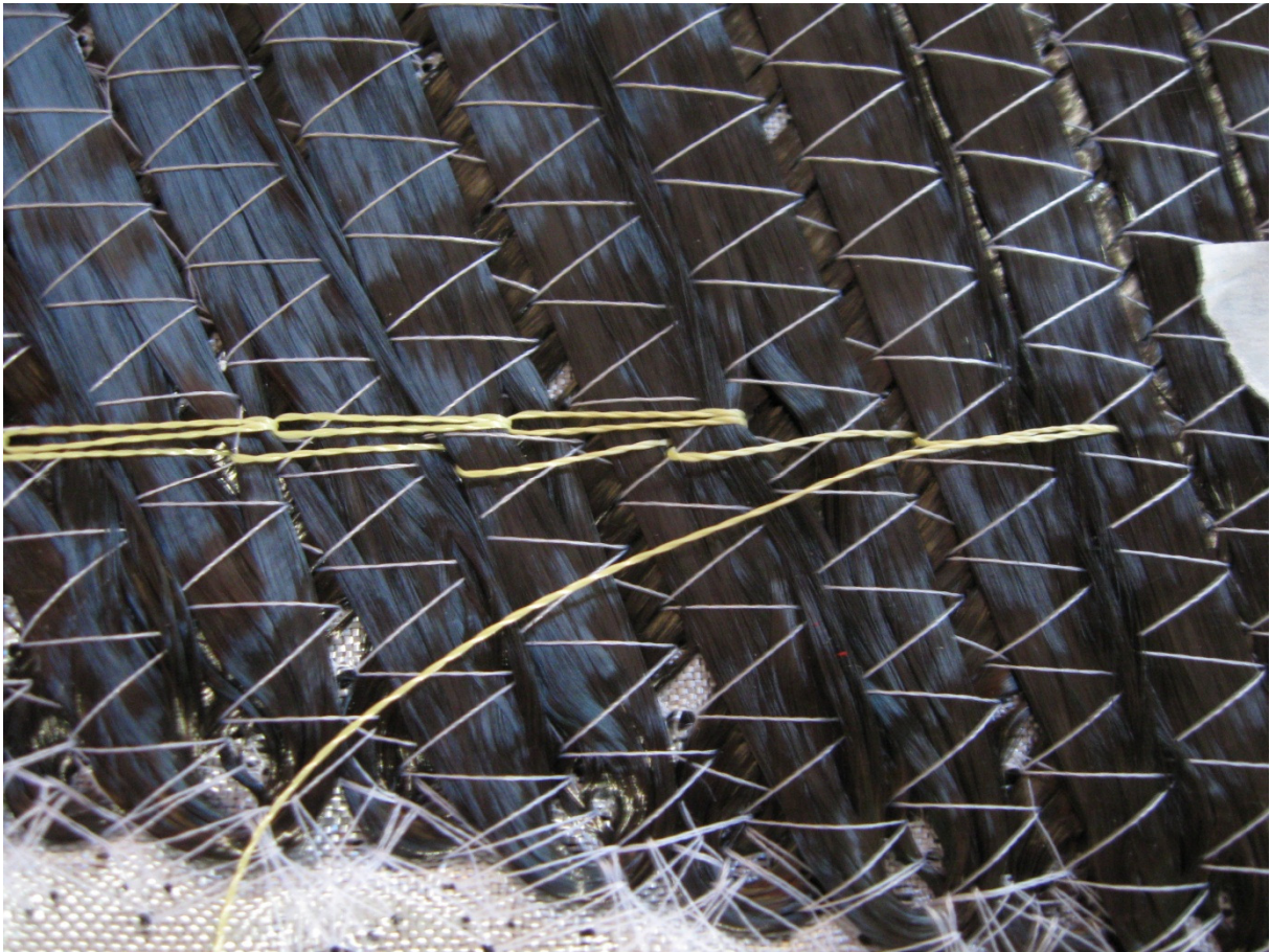
Abbildung 79: Darstellung der Vernähung von Probe 9; die 2 Fehlstiche und die korrekt ausgebildete anschließende Naht sind deutlich erkennbar
