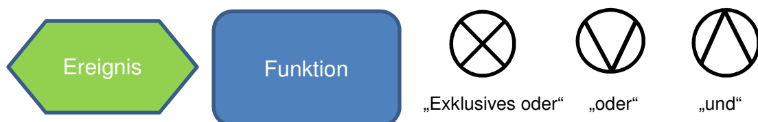
Abbildung 66: Die Basiselemente einer ereignisgesteuerten Prozesskette (ePK) (nach Scheer)
