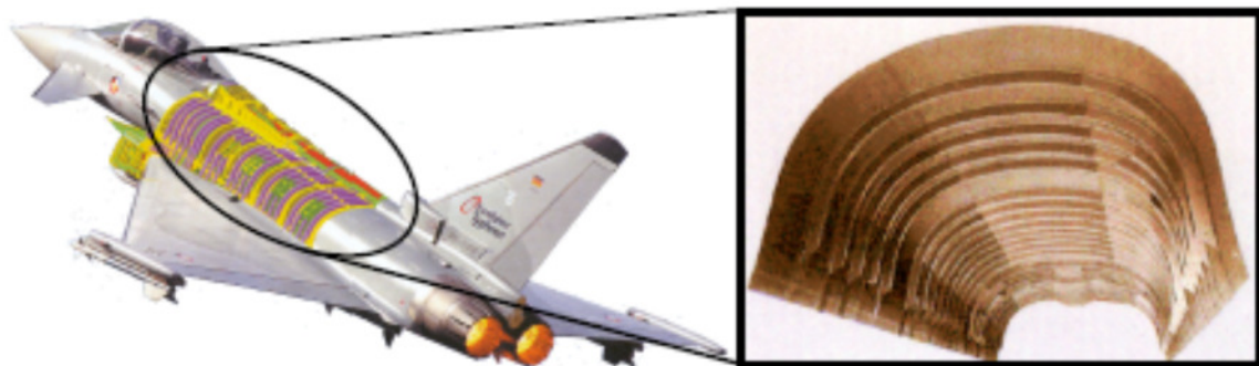
Abbildung 19: Versteifungsprofile am Kampfflugzeug (links) und Rumpfsseitenschale (rechts) [Körwien 2002]
