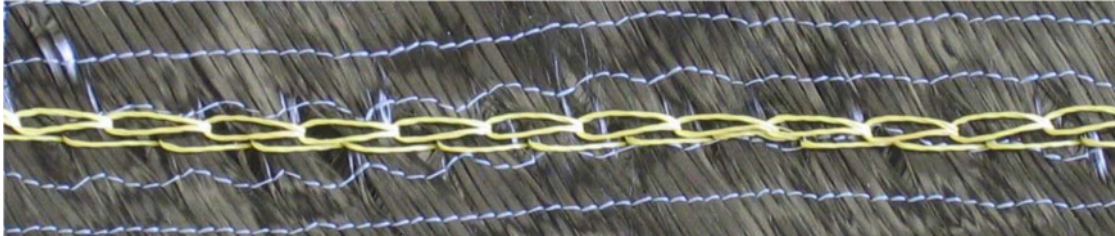
Abbildung 63: Blindstichnaht auf Multiaxialgelege mit Nähfaden Aramid 120tex [Steinhilber 2006]
