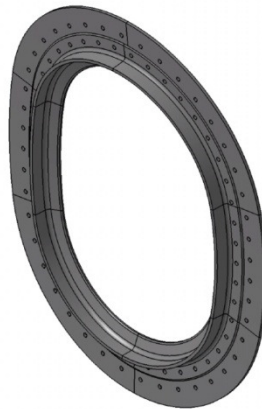
Abbildung 28: Prinzipielles Design des A380-Fensterrahmens (Quelle: Airbus)
