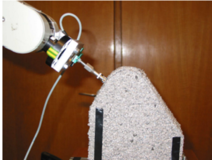
Abbildung 36: Versuchsaufbau zur Darstellung einer kraftregelten Bahnkurve [Resch 2005]
