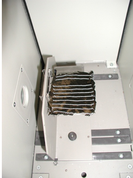
Abbildung 41: Eine Carbonhalbzeugprobe (hier: Standard-±45-Grad-Gelege der Firma SAERTEX) in der Probenkammer
