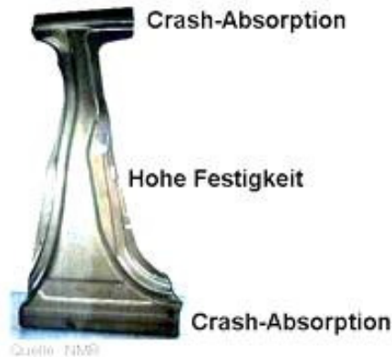
Abbildung 56: Die mechanischen Anforderungen an eine B-Säule im Automobilbau
