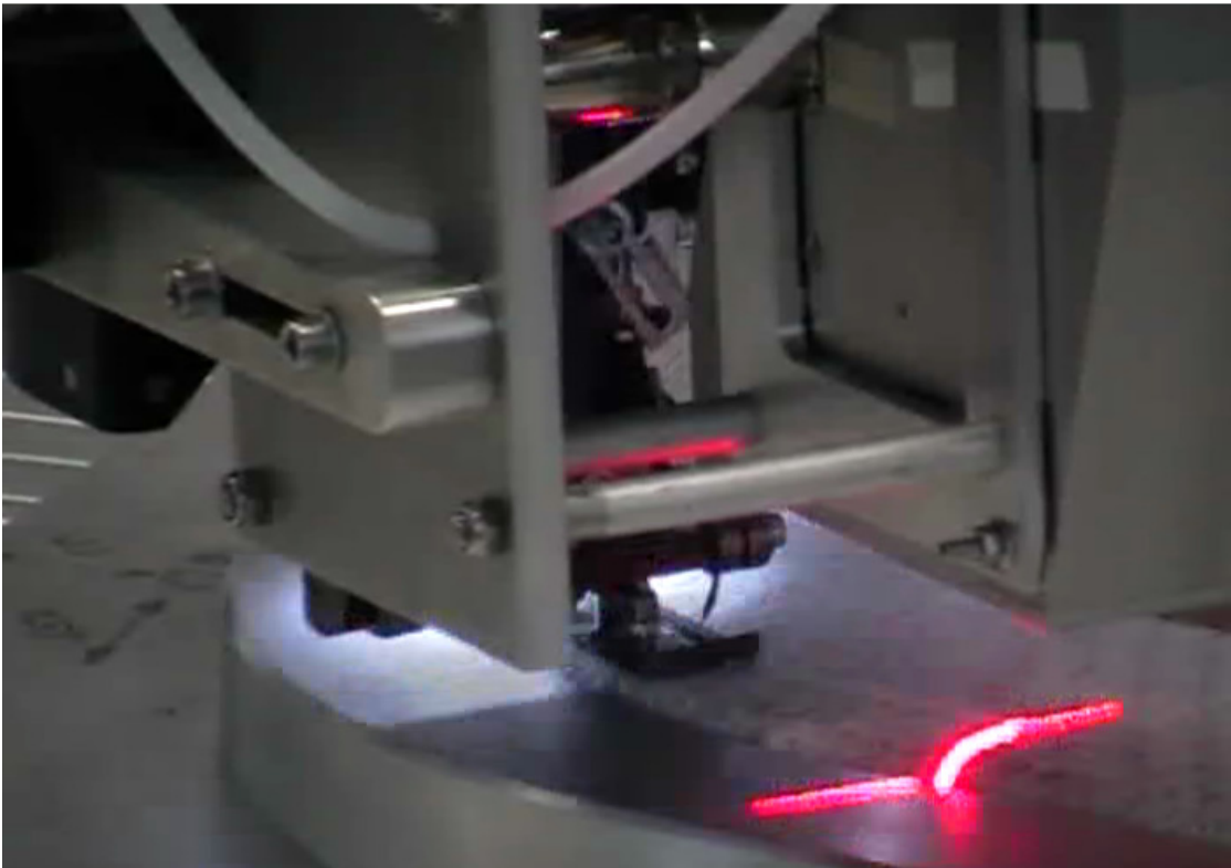
Abbildung 107: Praxistest der Roboternähanlage auf dem kleineren Radius der Fensterellipse
