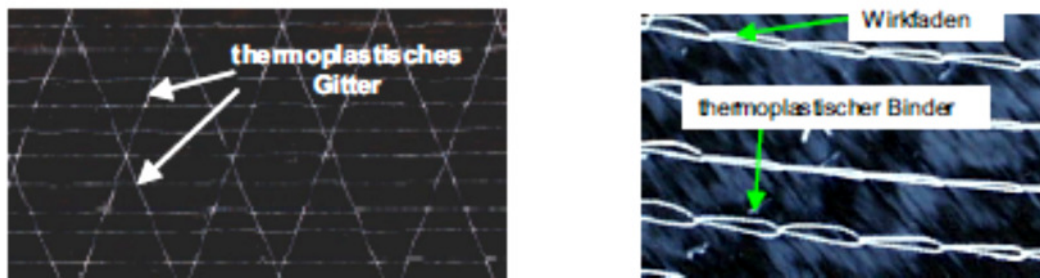
Abbildung 6: Gebündertes Multiaxialgelege (links) und hybrid gefertigtes Gelege (rechts) [Körwien 2002]
