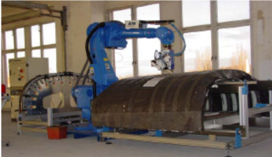
Abbildung 23: Vernähen der Spante auf der Rumpfseitenschale mit dem ALTIN-Nähkopf [Geßler et al. 2002]
