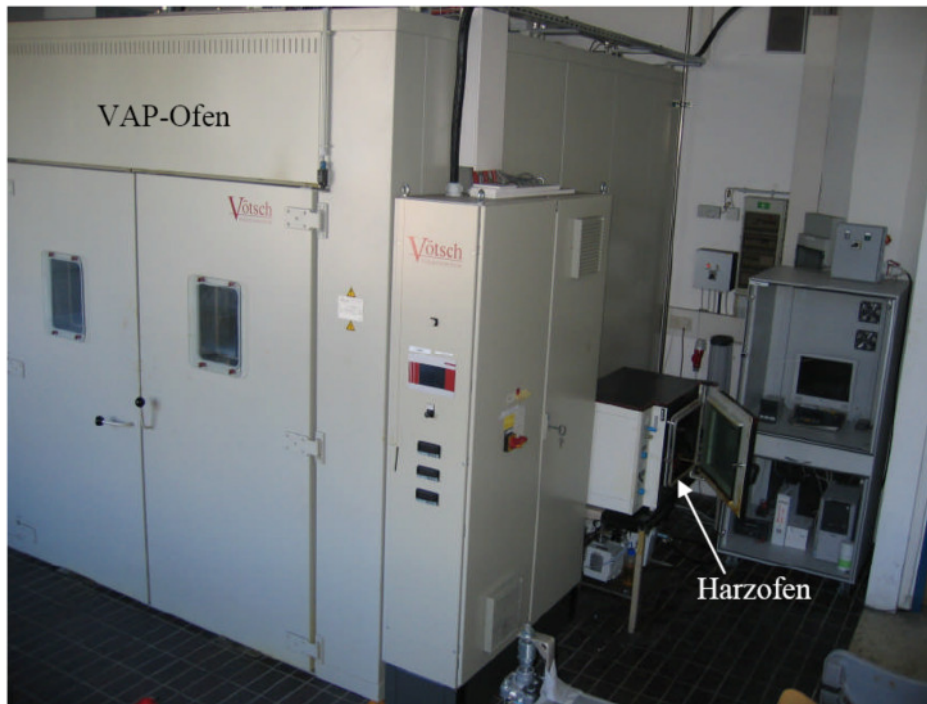
Abbildung 11: Der für den Aushärteprozess benötigte Ofen
