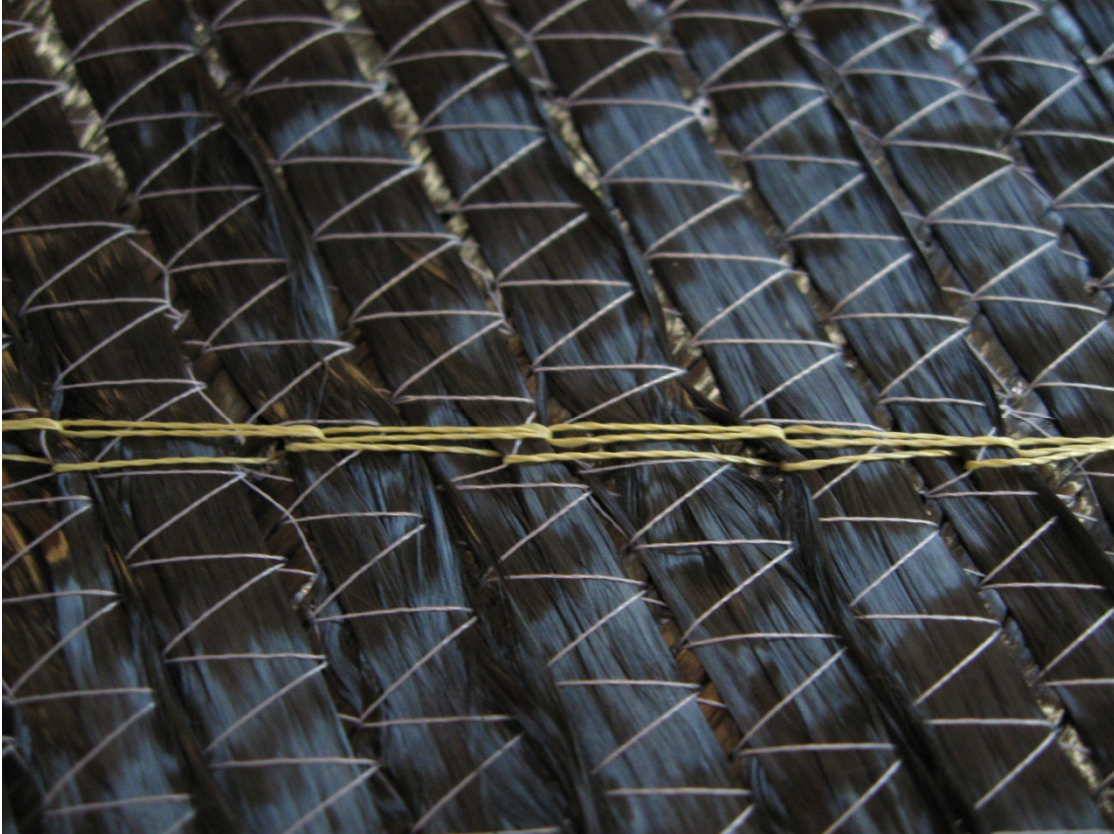
Abbildung 82: Detaildarstellung der Vernähung von Probe 6
