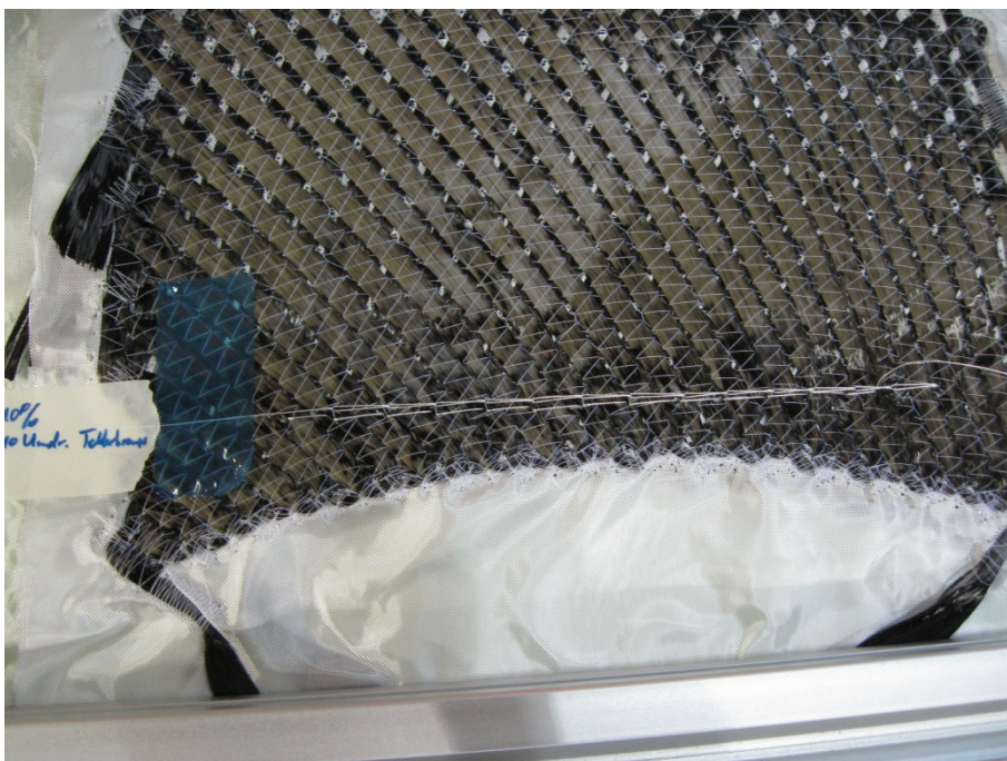
Abbildung 77: Darstellung der Vernähung von Probe 3
