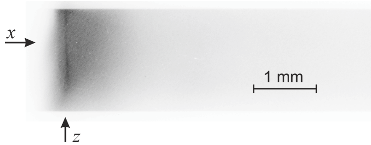
Abb. 5.18.: Optische Abbildung der Plasmaemission als invertierte Graustufendarstellung bei einer Machzahl von M_\infty = 2,1 ; x - Strömungsrichtung, z - Strahlausbreitung
