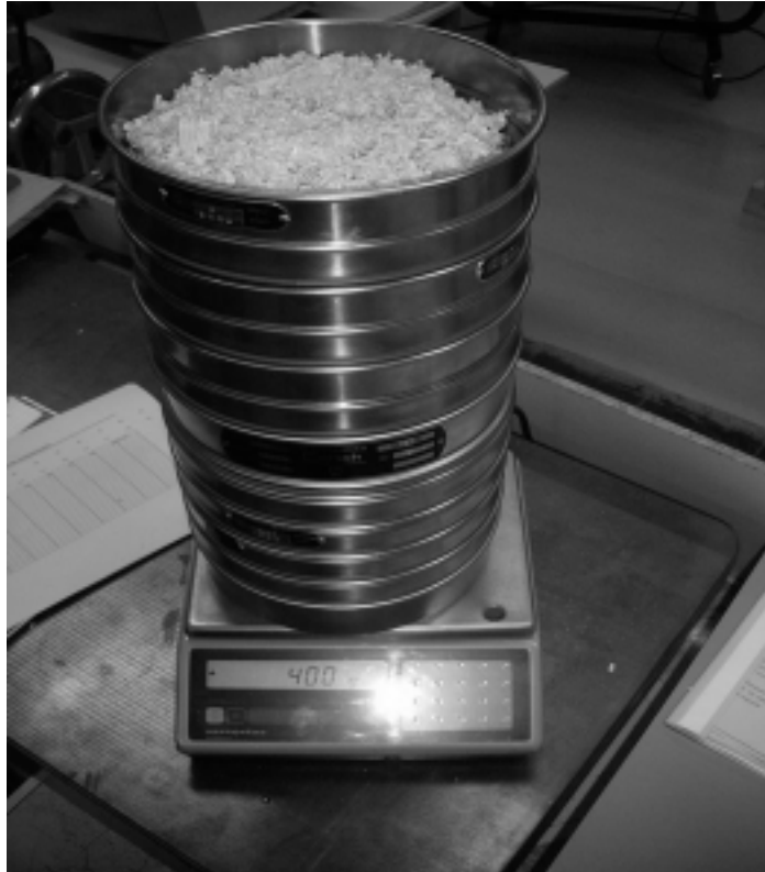
Bild 5.4: Analysewaage mit Siebsatz Fichtenspäne
