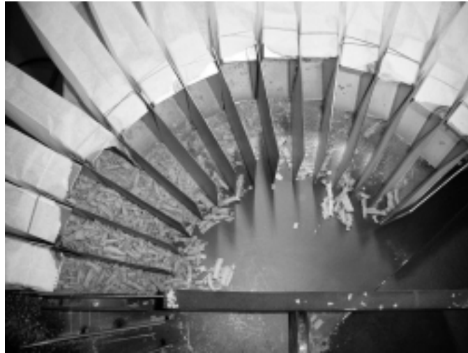
Bild 6.13: Versuchsaufbau bei Buche \alpha = 40^\circ
