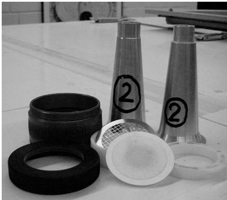
Abb. 4.14: Einzelteile des Filterkopfes; wechselbare Ansaugtrichter
