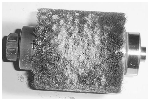
Abb. 5.1: Reststaub in der Bürste der Vergleichsstaubquelle
