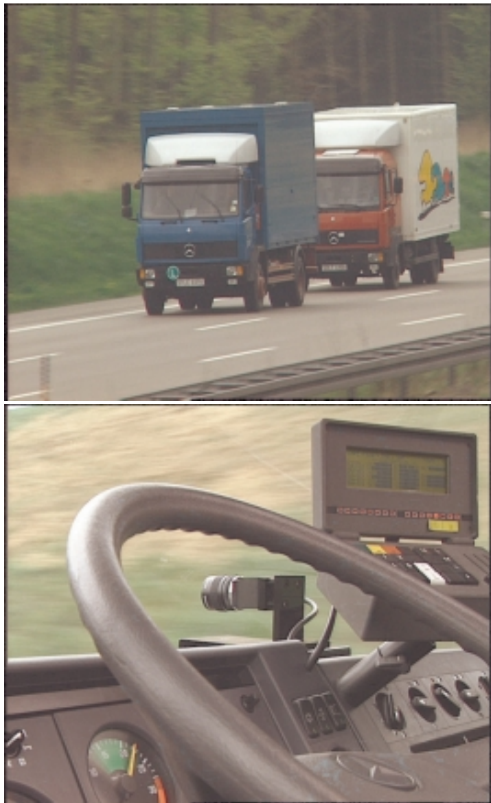
Abbildung 2.1: Oben: Die elektronische Deichsel mit dem Versuchsfahrzeug OT-TO als nachfolgendes Fahrzeug, unten: Die CCD-Kamera und das Driver Interface
