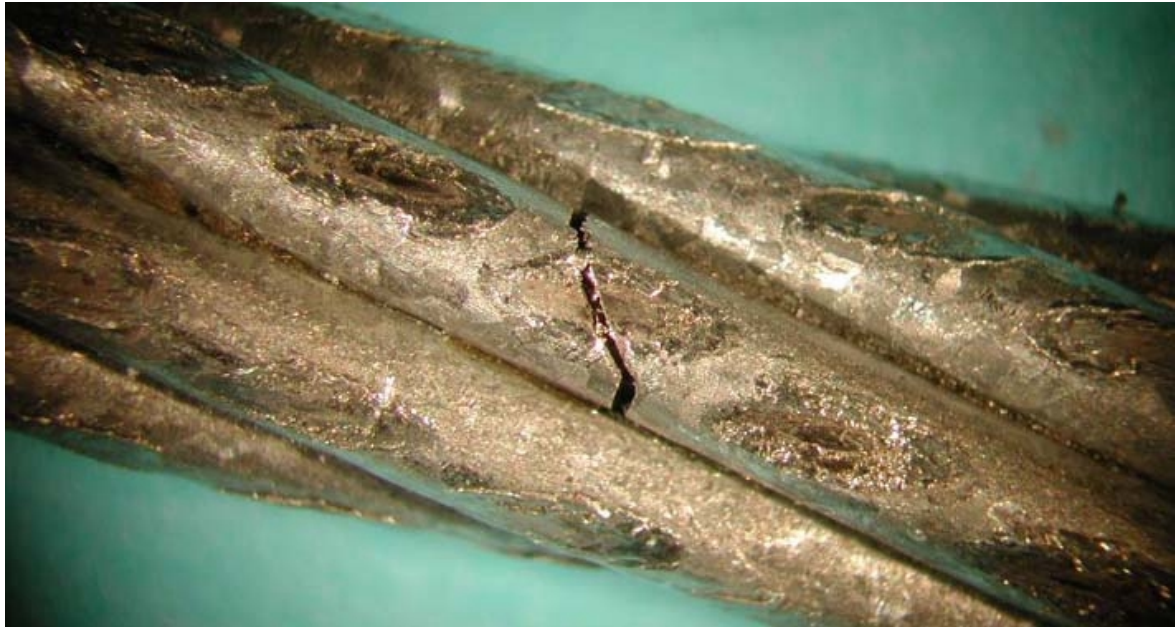
Bild 4.43: Pressmarken auf den Drähten der ersten Lage
