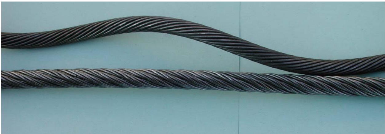
Bild 4.42: Seileinlage und Außenlitze des Seiles D nach 80.000 Schwingspielen für die Unterlast S_u/d^2 = 350 \text{ N/mm}^2
