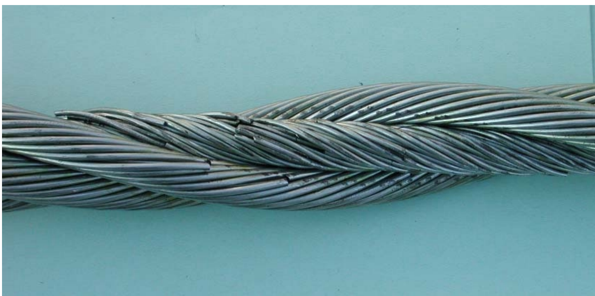
Bild 4.39: Geschädigte Seileinlage des Seiles C nach ca. 133.000 Schwingspielen
