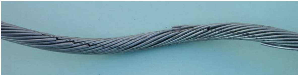
Bild 4.38: Litze nach Zugschwellversuch mit zahlreichen Drahtbrüchen (Seil C)
