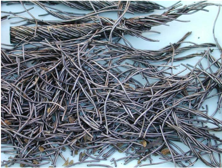
Bild 4.41: Fast vollständig zerstörte Seileinlage des Seiles D nach 33.000 Schwingspielen
