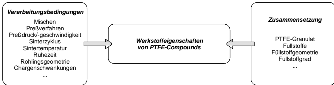
Bild 6.1: Einflußfaktoren auf die Werkstoffeigenschaften von PTFE-Compounds
