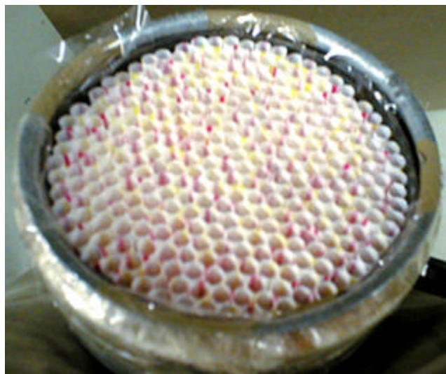
Bild 3.10: Strohhalmbündel als Strömungsgleichrichter
