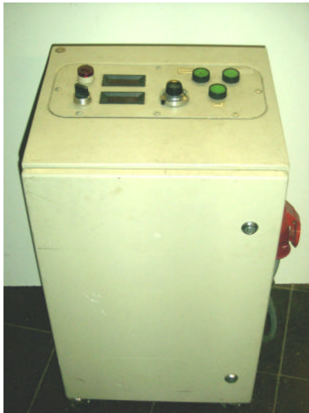
Bild 3.17: Frequenzumformer zur Drehzahlregulierung
