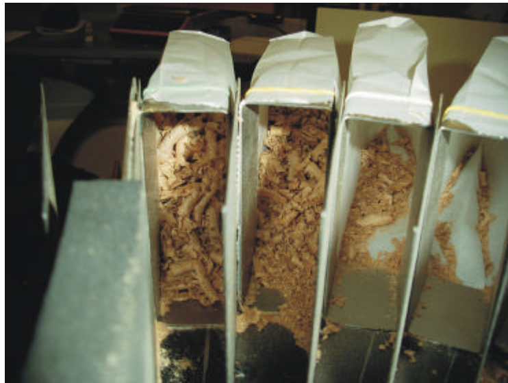
Bild 7.4: Späne in den Auffangelementen bei der Bearbeitung von Buche (Öffnungswinkel = 10 Grad)
