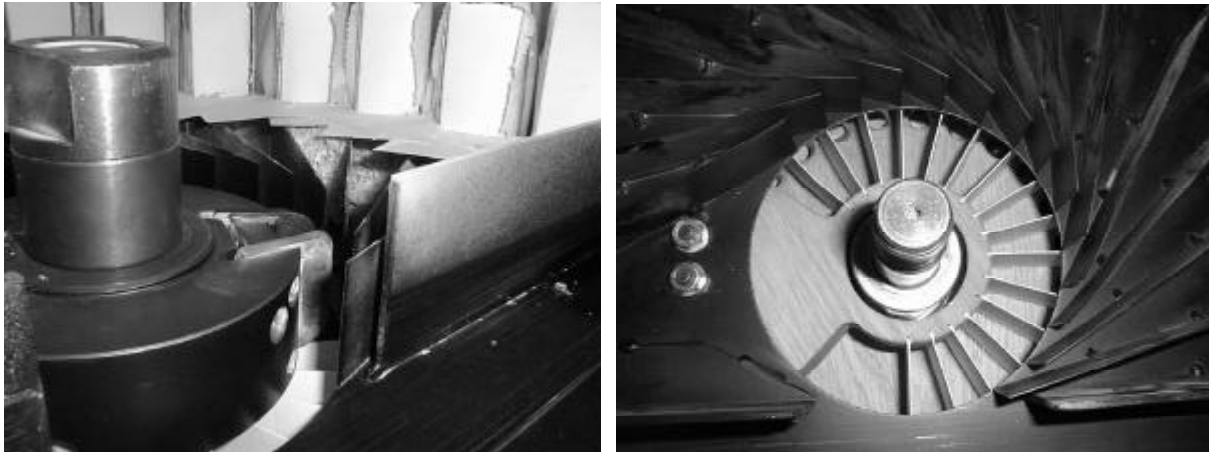
Bild 4.5: In Versuchsmaschine integrierte Späneerfassungselemente
