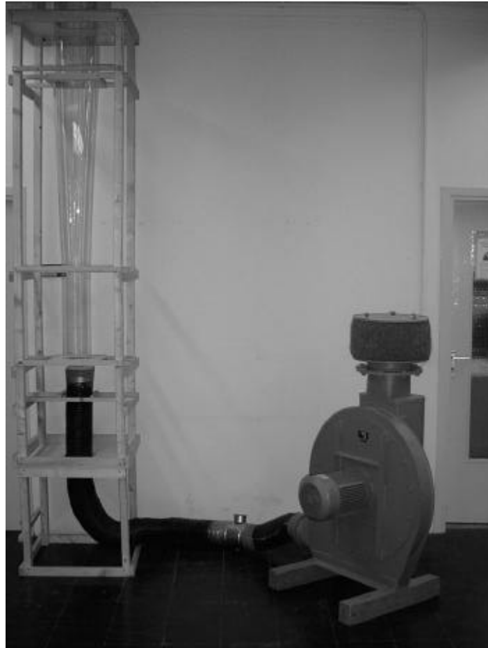
Bild 6.1: Versuchsaufbau bestehend aus Turm und Lüfter
