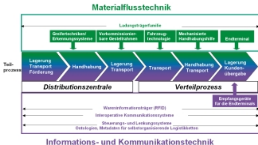
Abb. 13: Schlüsselkomponenten der Materialfluss- und Informationstechnologie für die Logistik des E-Commerce b2c.
