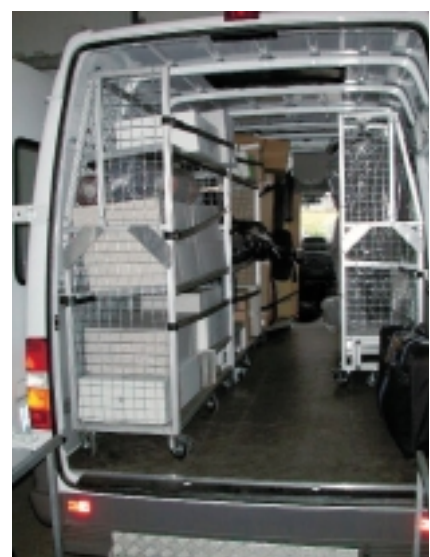
Abb. 9: Regalmodule im Verteilfahrzeug, Details: Modul für Hängekonfektion, Befestigungsmechanismus, Fahrzeug.
