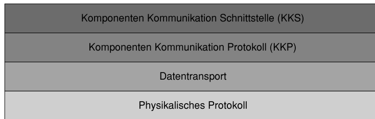
Abb. 5.3: Vier Schichten der standardisierten Schnittstelle
