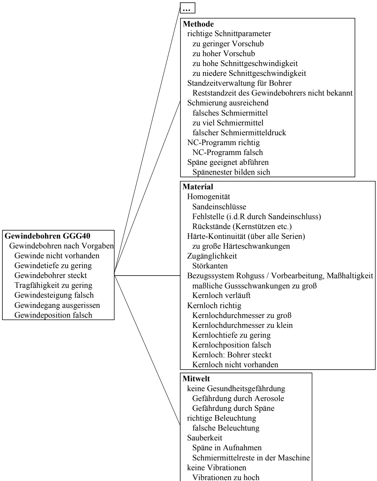
Abbildung 7.3b: Funktionsstruktur, Funktionen und Fehlfunktionen für den Standardprozess “Gewinden“
