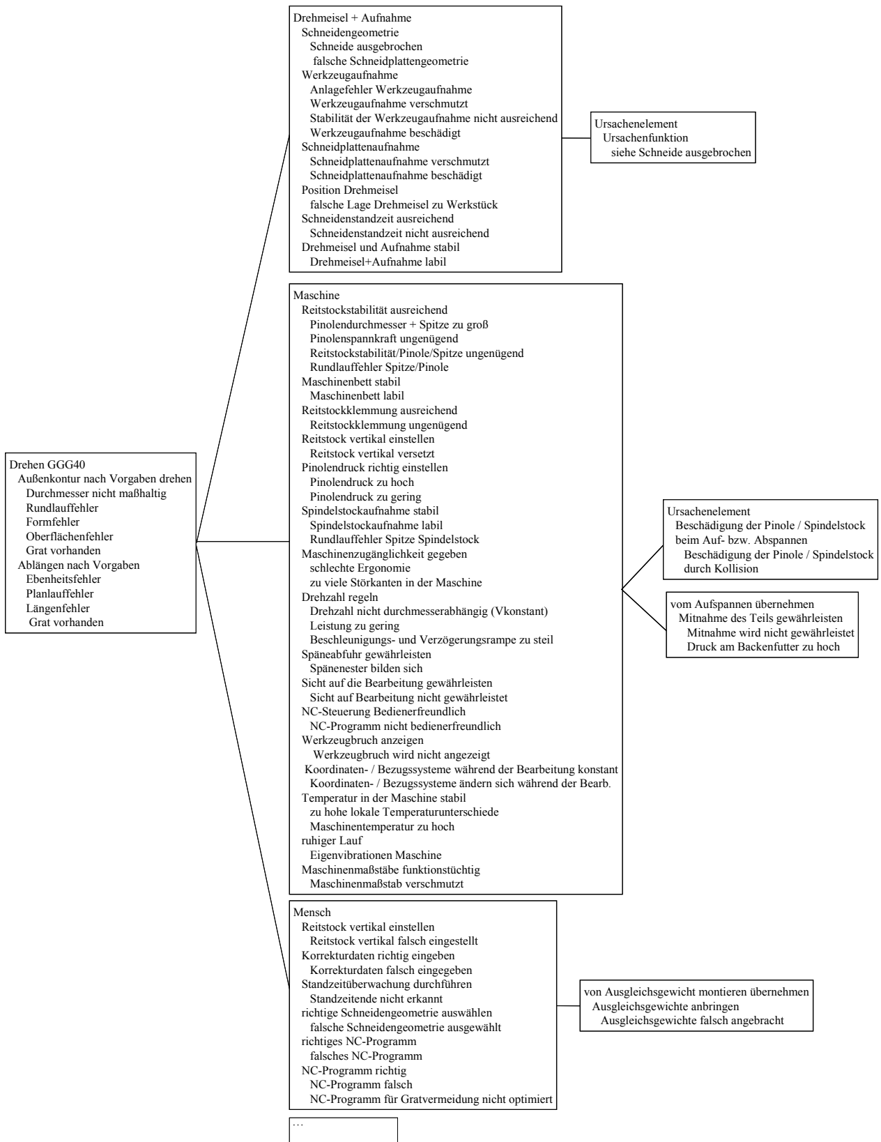
Abbildung 11.3a: Funktionsstruktur, Funktionen und Fehlfunktionen für den Standardprozess „Drehen“
