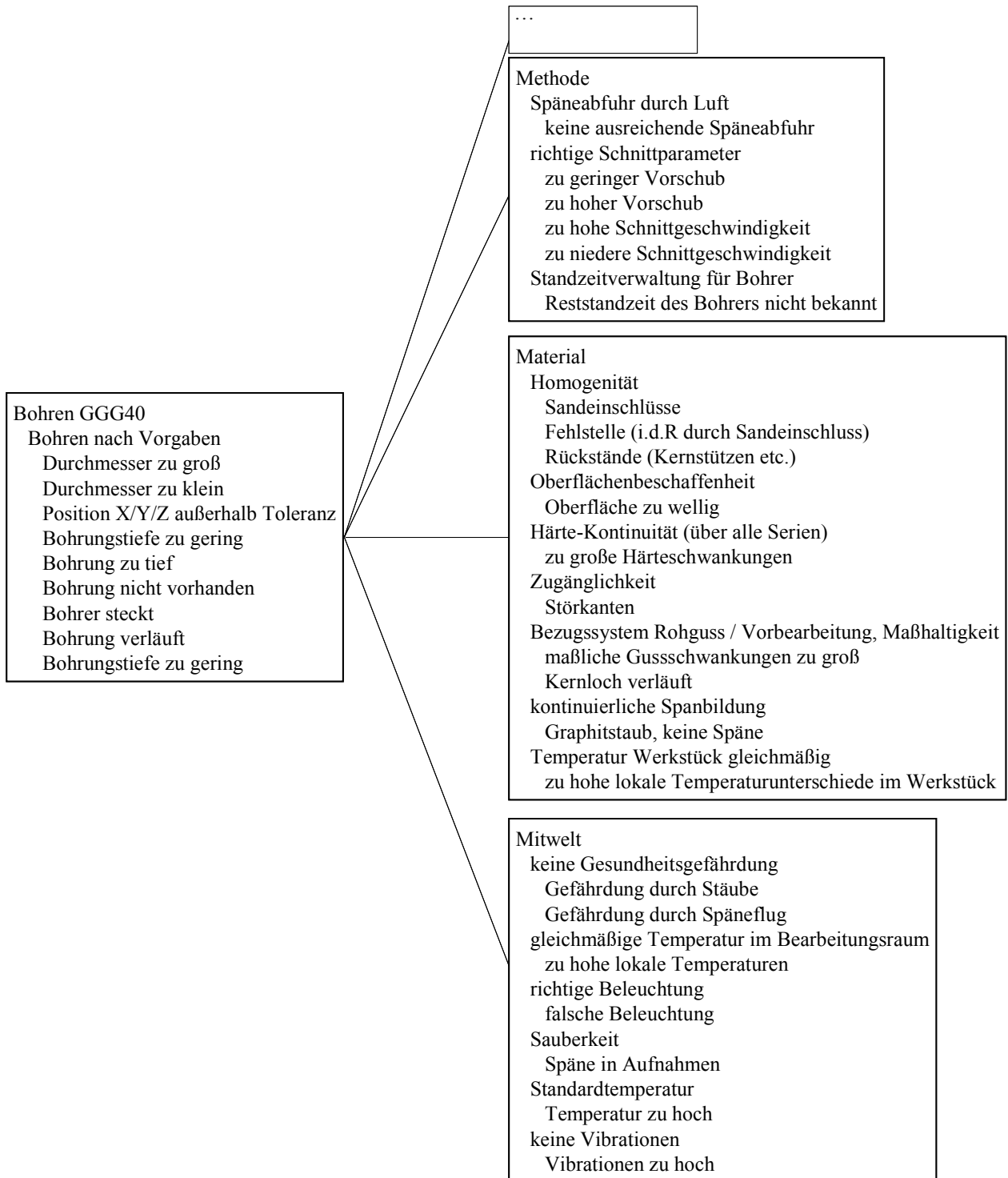
Abbildung 11.5b: Funktionsstruktur, Funktionen und Fehlfunktionen für den Standardprozess „Bohren“
