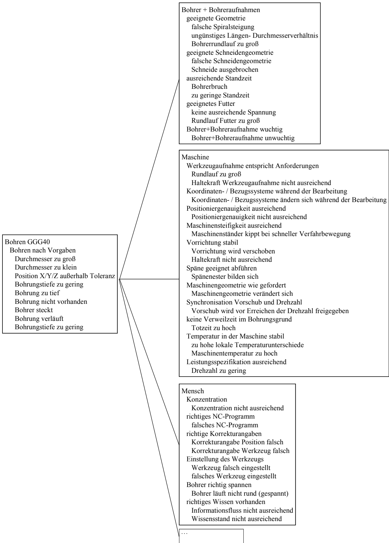
Abbildung 11.5a: Funktionsstruktur, Funktionen und Fehlfunktionen für den Standardprozess „Bohren“
