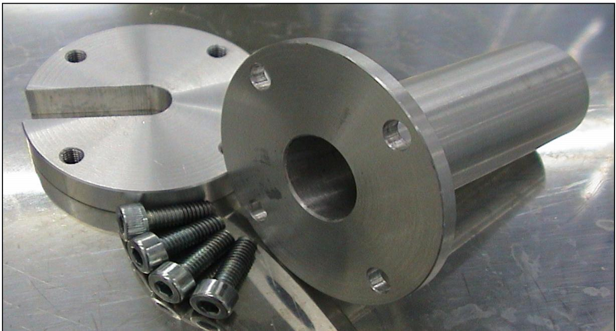
Abbildung 5-5: Angefertigte zylindrische Hülse aus Aluminium
