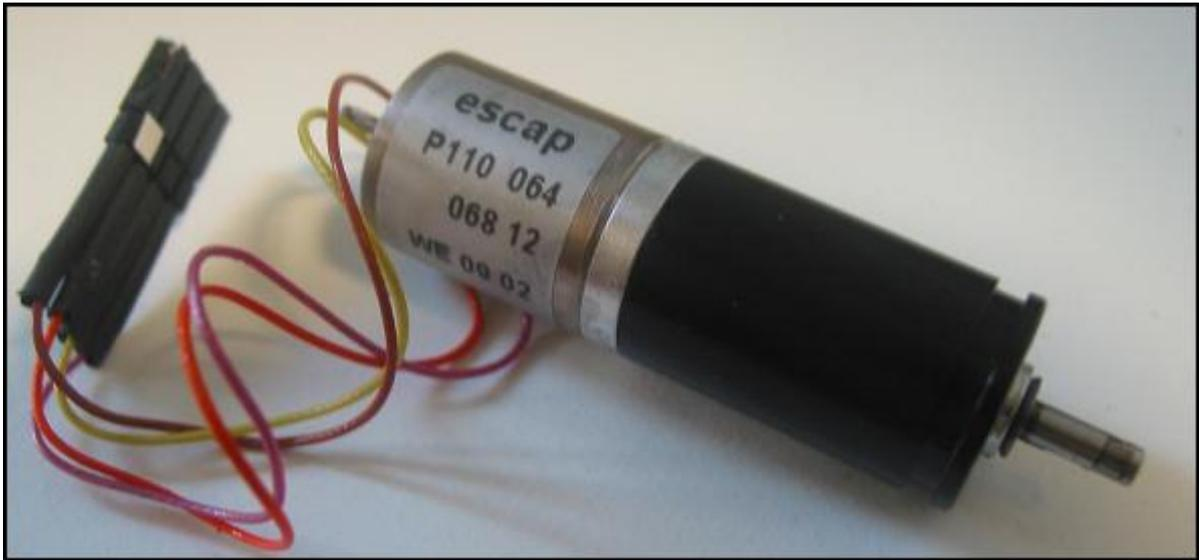
Abbildung 5-3: Mikroschrittmotor der Firma escap
