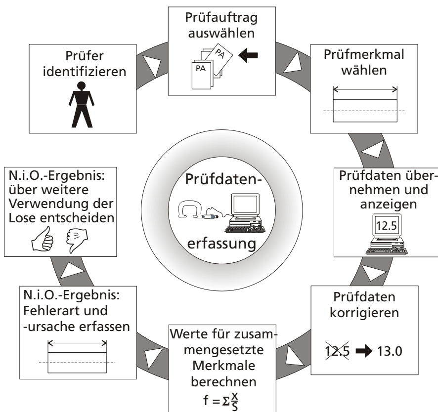
Abbildung 2.13: CAQ-Systeme unterstützen den Anwender bei der Durchführung von Prüfungen. Das System führt den Prüfer durch die einzelnen Arbeitsschritte und nimmt eine automatische Bewertung der Prüfdaten aufgrund der eingegebenen Vorgaben vor.
