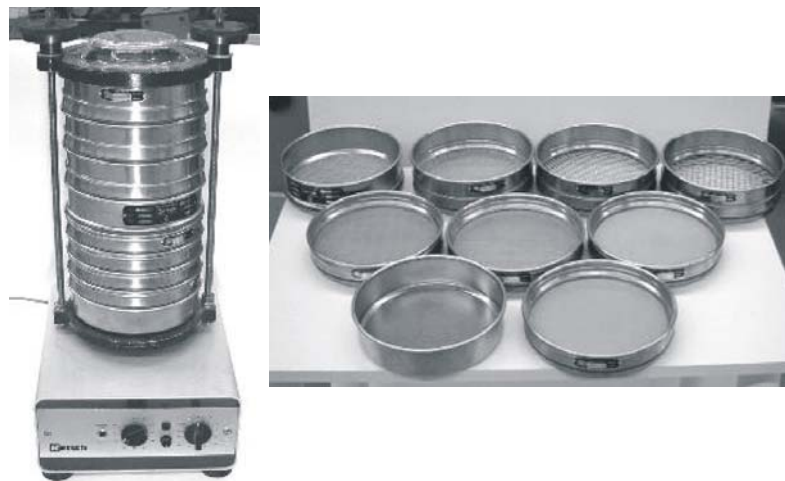
Bild 5.2: Siebmaschine und Siebsatz für Maschinensiebung
