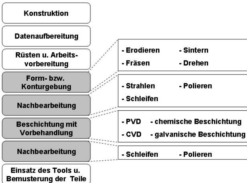
Abbildung 9-2: Technologische Prozesskette des Rapid Tooling
