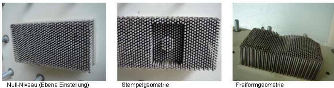
Abbildung 9-6: Erzeugte Anodengeometrien mittels eines Stiftemodells
