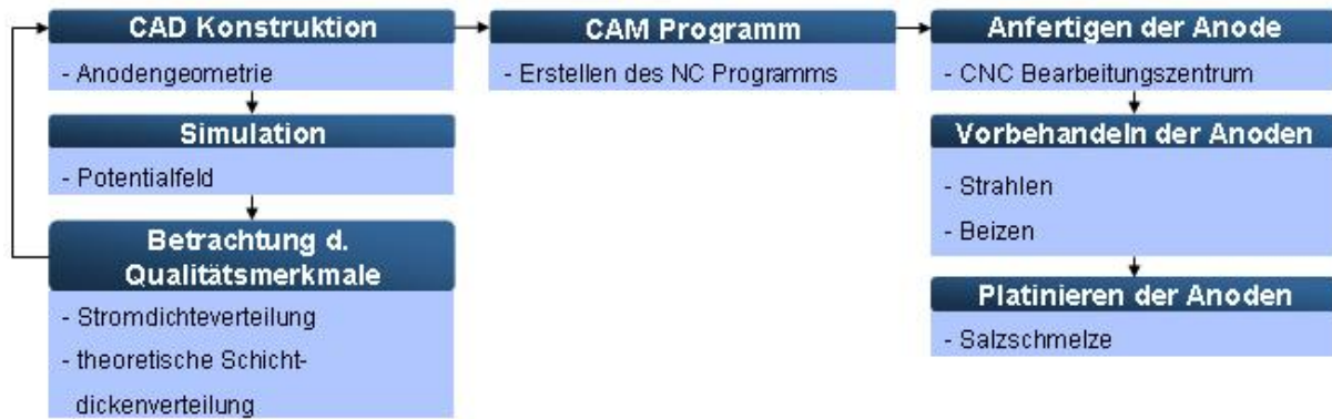
Abbildung 9-3: Teilschritte zur Herstellung einer konventionellen formangepassten Anode
