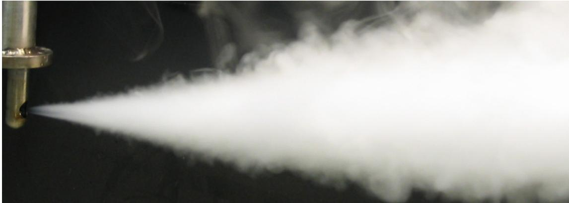
Abbildung 5.5: Zerstäubungsqualität des Atomizers mit Dieselkraftstoff unter Umgebungsbedingungen
