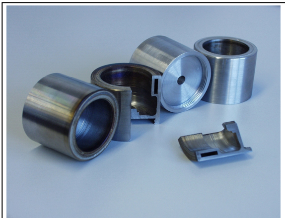
Bild 5.4 : Stößel nach dem Einschweißen des Bodenrings und fertig bearbeitet
