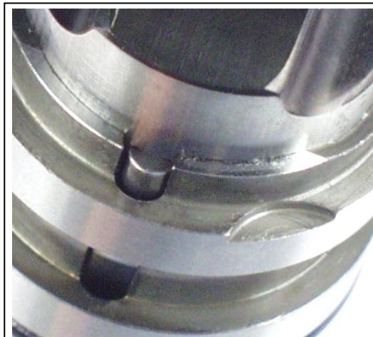
Bild 5.35 : Verdrehsicherung durch Pin im Stößel
