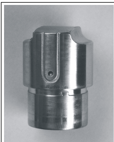
Bild 5.30 : Stößel mit U-förmiger Entlüftungsnut
