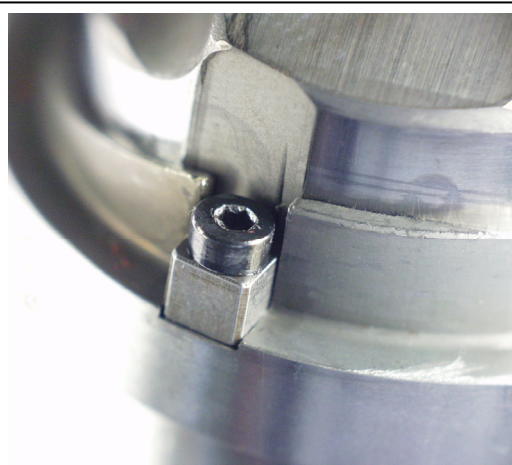
Bild 5.34 : Verdrehsicherung durch Flachführung am Stößel
