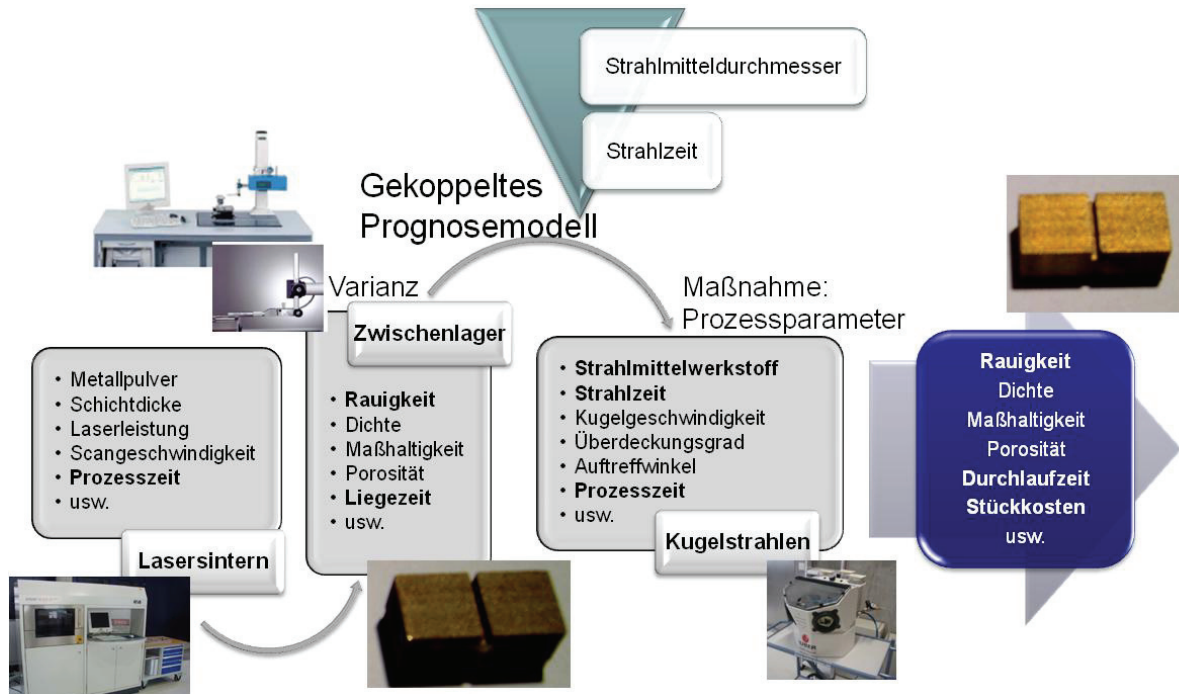
Abb. 6- 2 Nutzen einer gekoppelten Modellierung am Beispiel der Prozessfolge Lasersintern - Kugelstrahlen
