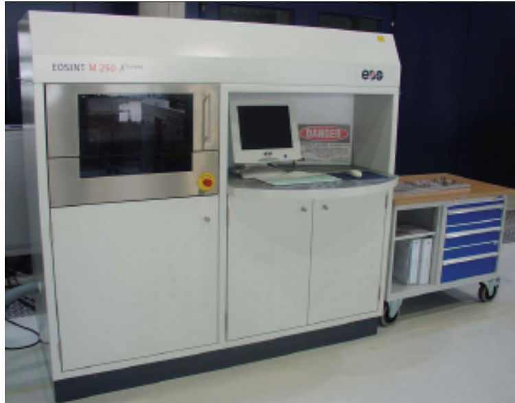
Abb. 8- 9 Lasersinteranlage EOSINT M 250 am IFF
