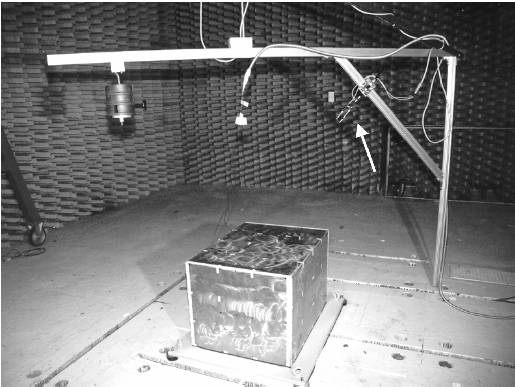
Bild 2.12: Untersuchte Maschinenkapsel mit Scanning-Einrichtung für das Schallintensitäts-Hüllflächenverfahren (Schallintensitätssonde an der Scanning-Einrichtung).
